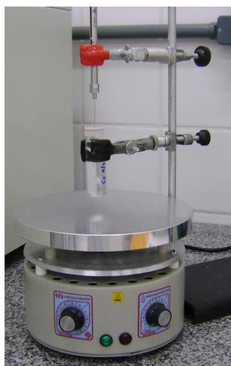
FIGURA 13. Procedimento de micro extração em fase sólida em *vial headspace*.
