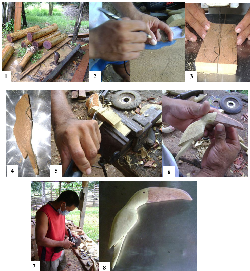
Figura07- Descrição do processo produtivo de um entalhe confeccionada por um artesão de Acajatuba: 1. Matéria-prima utilizada (madeira). 2. Desenho com gabarito. 3. Primeiros cortes na serra de fita. 4. Peça pré-cortada. 5. Entalhe com o uso do formão. 6. Peça entalhada. 7. Processo de lixamento. 8. Peça pronta. Fonte: pesquisa de campo.
