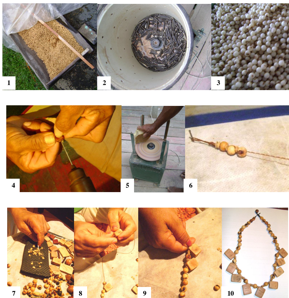
Figura 06- Descrição do processo produtivo de uma bijuteria confeccionada por uma artesã de Acajatuba: 1. Secagem da semente. 2. Lixamento das sementes. 3. Sementes lixadas. 4. Furação das sementes. 5. Preparação para o polimento das sementes. 6. Início da confeção do colar. 7. Perfuração da semente com agulha. 8 e 9. Colocação das sementes e contas de madeira no fio encerado. 10. Colar finalizado. Fonte: pesquisa de campo.
