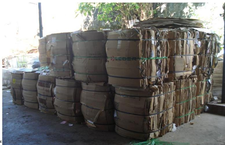
Figura 7 - Forma de empilhamento dos fardos de aparas após a prensagem
