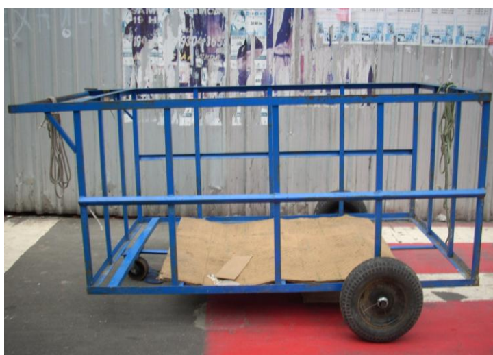
Figura 22-Carrinho produzido com chapas de metalon.
