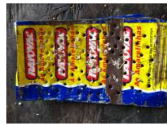
Figura 36. Ralador fabricado com lâminas de pilhas.
