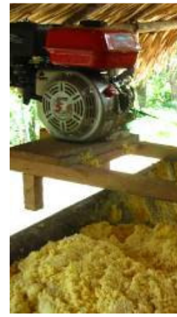
Figura 41. Ralador motorizado para mandioca.
