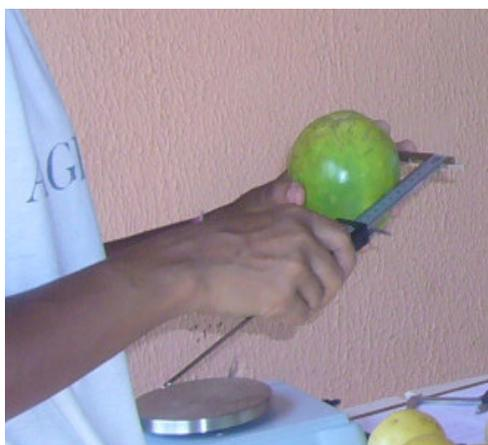
Figura 8 - Obtenção do comprimento e diâmetro com auxílio do paquímetro manual.
