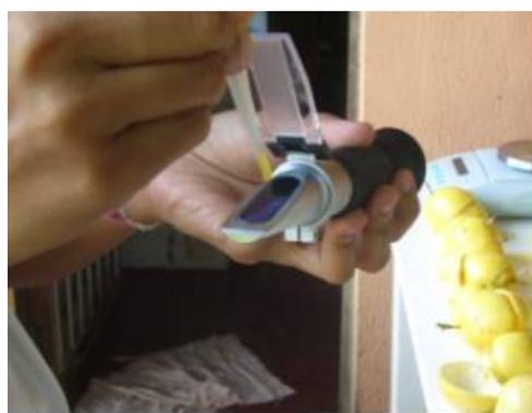
Figura 9 - Obtenção do grau Brix pelo refratômetro digital.
