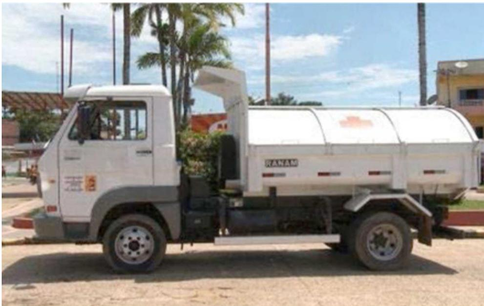
**Figura 25:** Caminhão coletor de resíduo hospitalar. **Fonte:** Plansam (2012).
