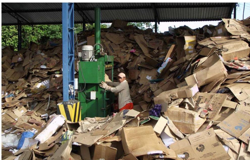
**Figura 30:** Prensa dos resíduos no aterro sanitário em Coari. **Fonte:** Administração do Aterro Sanitário de Coari (2011).
