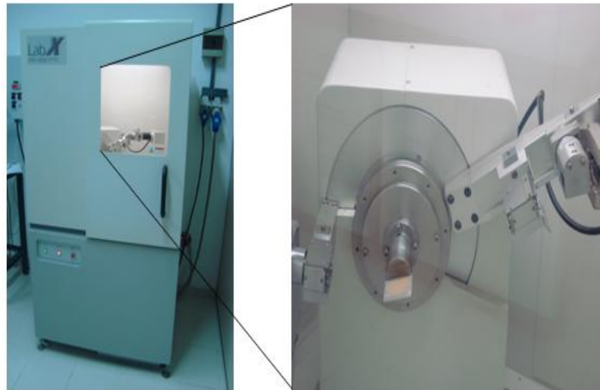
Figura 13: Difratômetro de raios – X modelo Shimadzu XDD 600. Regiane Campos Magalhães, 2011.
