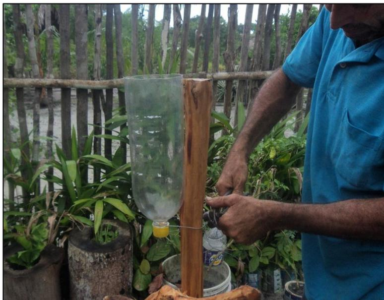
**Figura 10:** Pluviômetro do tipo rudimentar (garrafa pet) ETM
