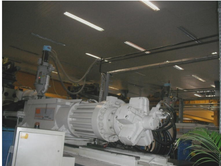
Figura 3: Máquina (robô) injetora, canhão e tubovias ao alto. Fonte: EIPLAM, 2011.
