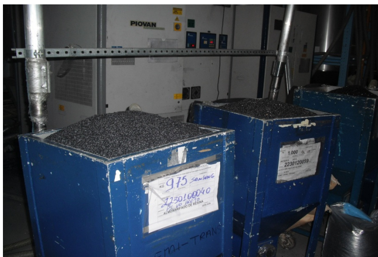
Figura 2: Alimentação da silagem plástico na cor preta. Fonte: EIPLAM, 2011.
