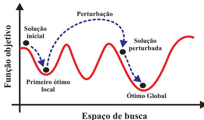
Figura 2.5: Funcionamento do algoritmo de busca local iterada em um determinado espaço de busca.
