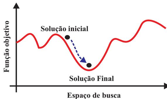
Figura 2.3: Funcionamento do algoritmo de busca local em um determinado espaço de busca.
