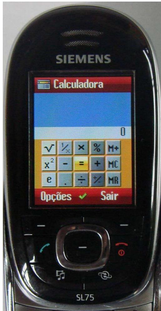
Figura 5.5: Calculadora no modo expandido (aplicativo embarcado no celular BenQ-Siemens SL75).
