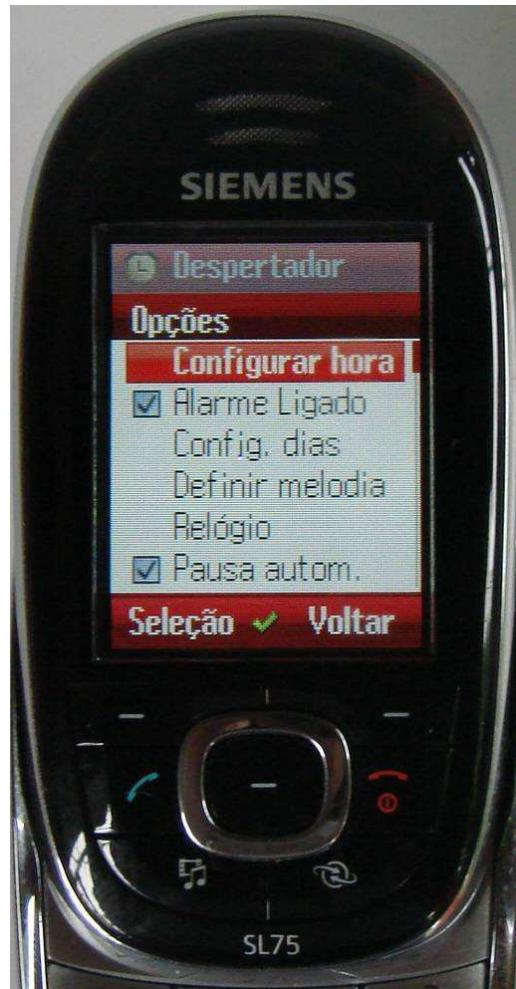
Figura 5.8: Lista com alguns *Commands* com checkbox (“Alarme ligado” e “Pausa autom,”) indicando que a tarefa está no estado ativo.
