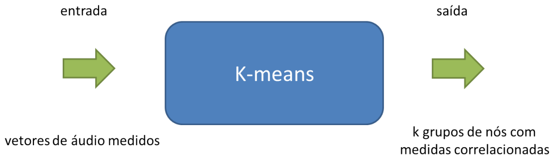
Figura 3.3. Proposta para particionar a região de interesse. O k -means será aplicado sobre os vetores de áudio coletados pelos nós sensores e retornará os grupos de nós com medidas correlacionadas.
