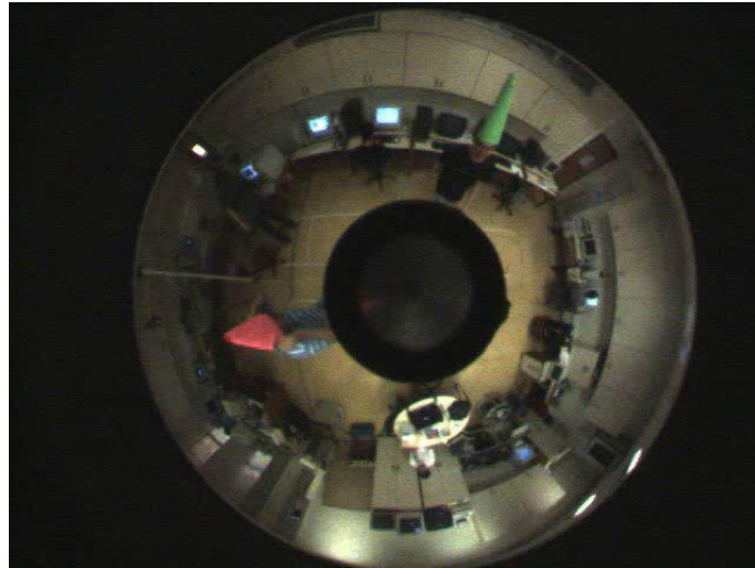
Figura 2.2: exemplo de imagem obtida por uma câmera catadióptrica. Este tipo de sistema é caracterizado por uma câmera anexada a um espelho convexo. (Santos, 2006)
