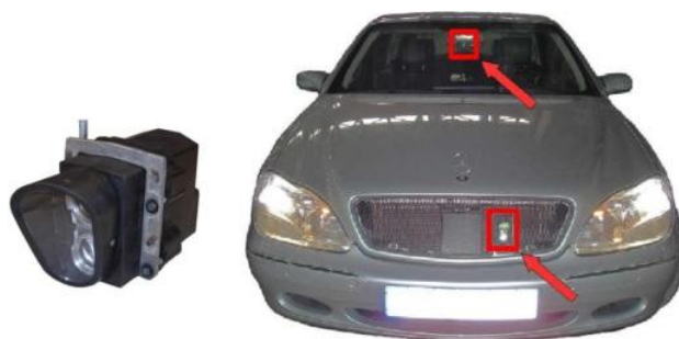
Figura 2.5: Disposição dos sensores em um veículo automotivo utilizado para experimentação.
