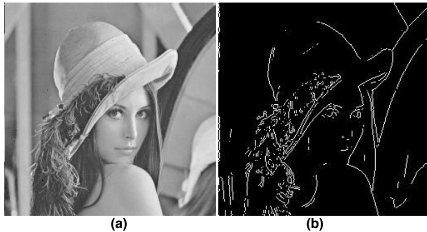
Figura 2.2: Resultado de Segmentação: (a) imagem original (b) imagem segmentada através de detecção de borda.
