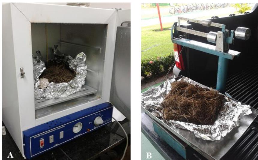
**Figura 6** – A) Amostra na estufa a 75 °C; B) Amostra sendo pesada
