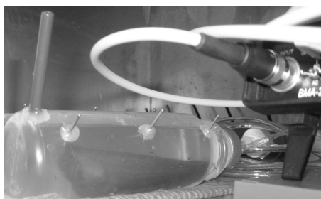
Figura 52 – Tubo experimental (750 ml) para BTEX com sistema de aeração constante.
