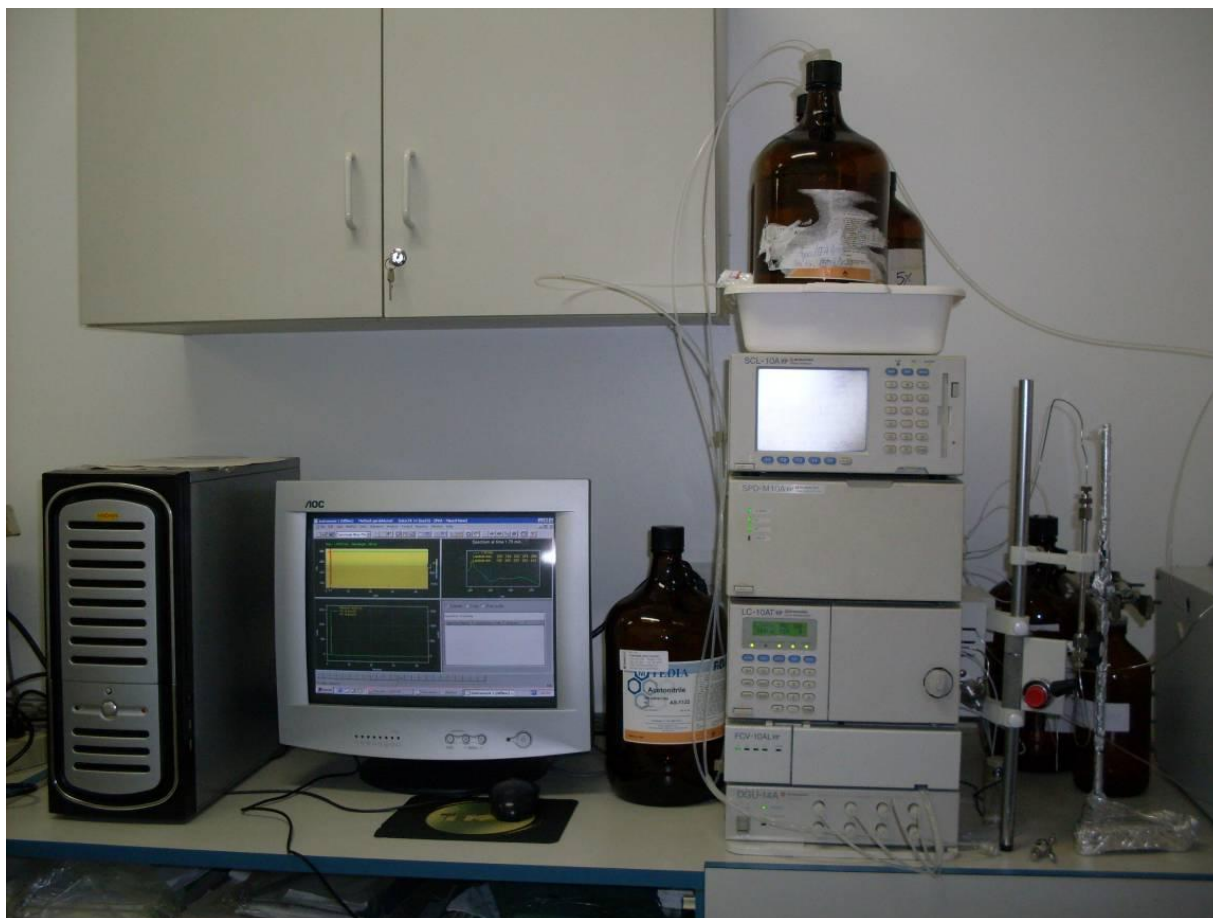
Figura 19. Cromatógrafo DAD – Shimadzu SPD – M10Avp, equipado com coluna Kromasil®.
