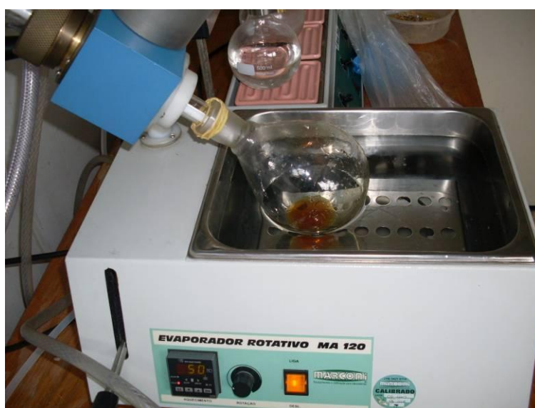
Figura 18- Concentração do extrato em evaporador rotativo.
