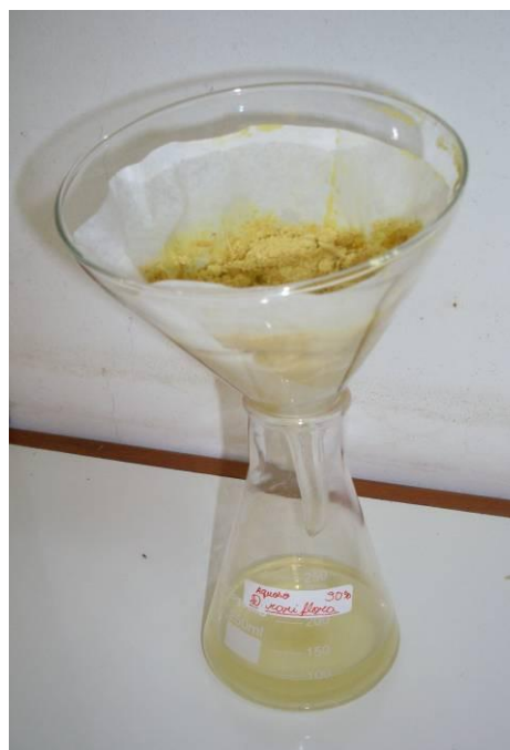
Figura 17- Procedimento de filtragem do extrato aquoso de timbó em papel filtro Mellita ® . Foto: Raquel Corrêa.
