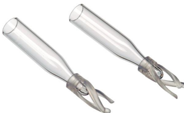
Figura 84: Inserte empregado para aumentar a concentração da fração volátil de Trochospongilla paulula para análise por cromatografia em fase gasosa.
