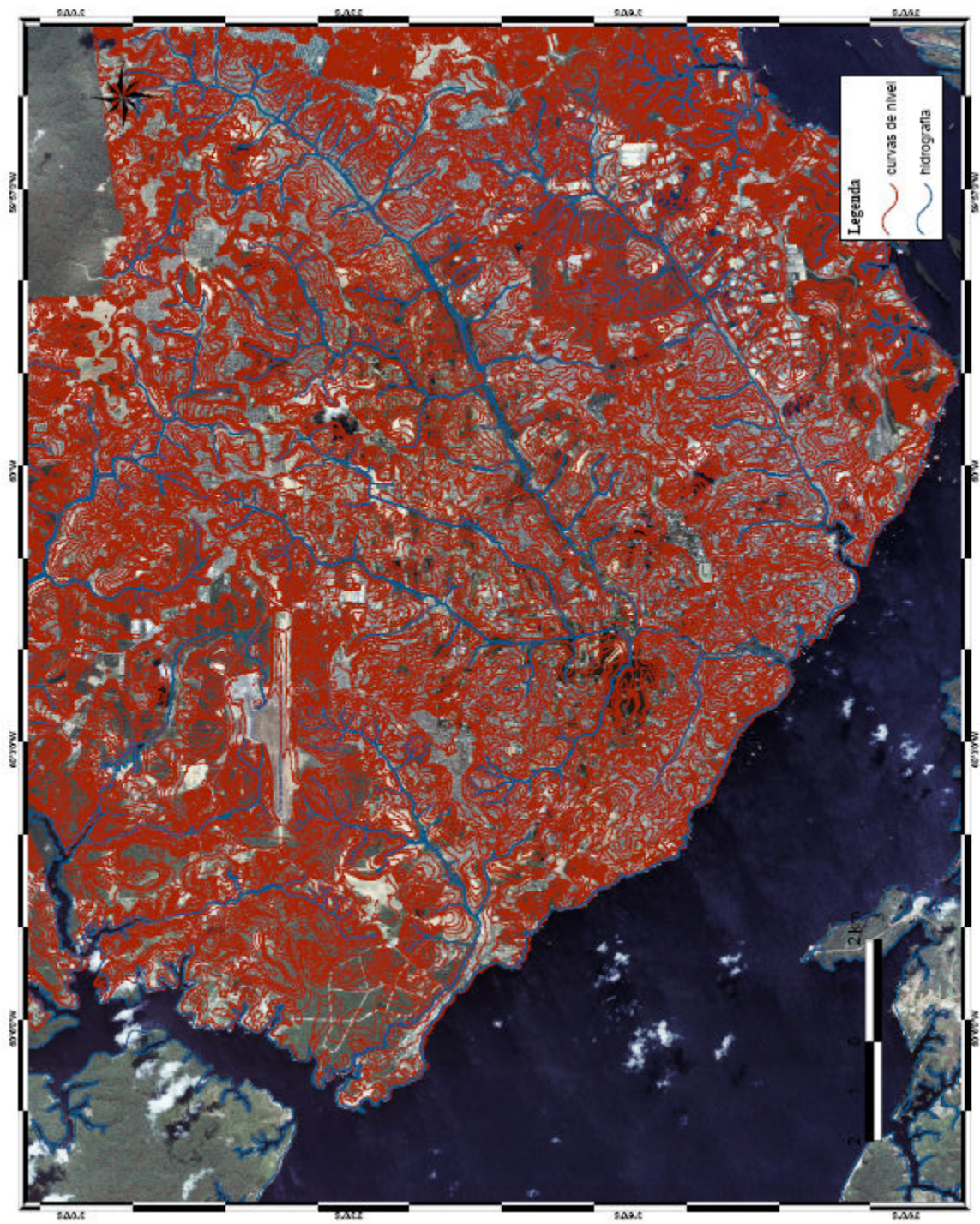
Figura 5.21 – Mapa da rede de drenagem e curvas de nível sobreposta a imagem Ikonos-II, área urbana da cidade de Manaus.
