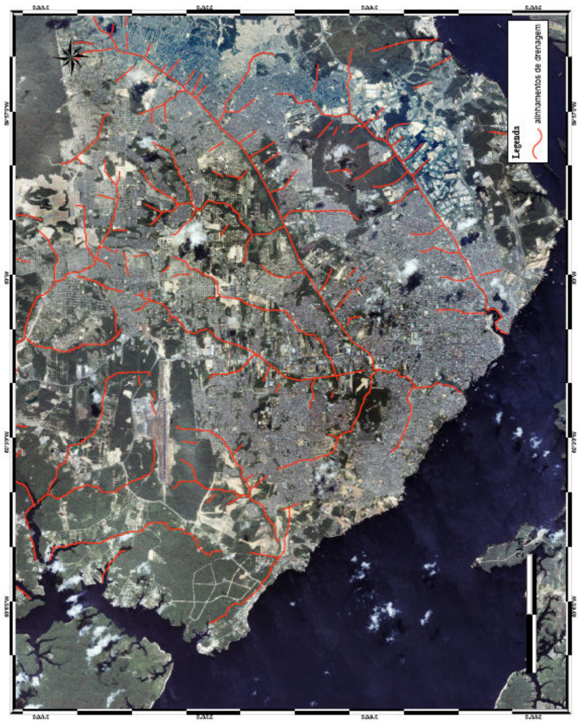
Figura 5. 22 – Mapa de feições curvilíneas (alinhamentos de drenagem), sobreposta a imagem Ikonos da cidade de Manaus
