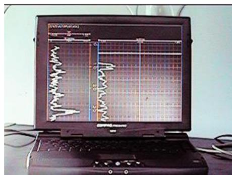
Foto 2 – Equipamento portátil de perfilagem geofísica. Detalhe do Notebook que apresenta a leitura gerada na sonda perfiladora.
