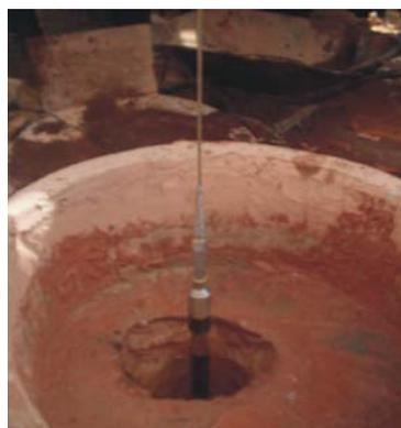
Foto 3 – Equipamento portátil de perfilagem geofísica. Detalhe da sonda entrando no furo-guia.
