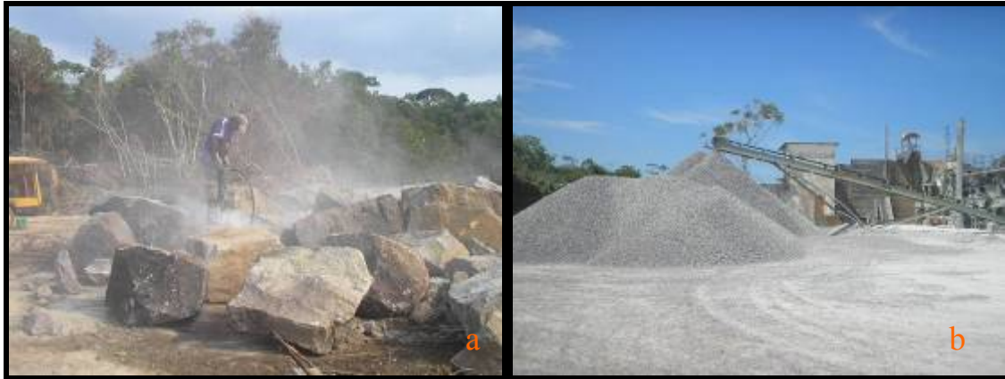
Figura 3.6 – a) Quebra de blocos graníticos. b) Britas trituradas para destinação da construção civil.
