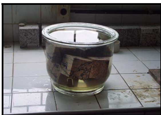
Figura 4.1 – Imersão dos corpos de prova para obtenção do peso saturado ou massa B.
