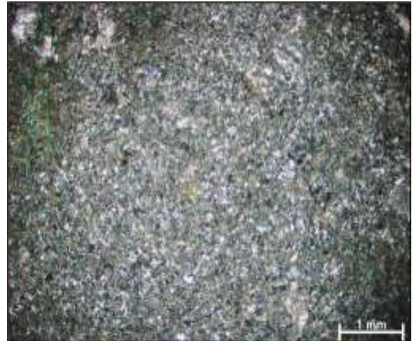
Figura 2.26. Aspecto microtextural da matriz do diabásio, textura sub-oftítica.
