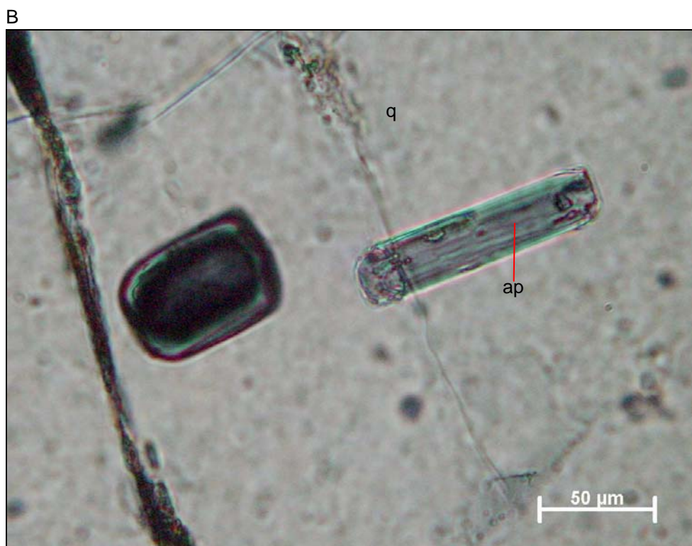
FIGURA 7.38 – Fotomicrografias da amostra SR-L-63 (Formação Boa Vista). A – Zircão (z) e quartzo (q) – nicóis x B – Cristal de quartzo (q) com inclusão de apatita (ap) – nicóis x
