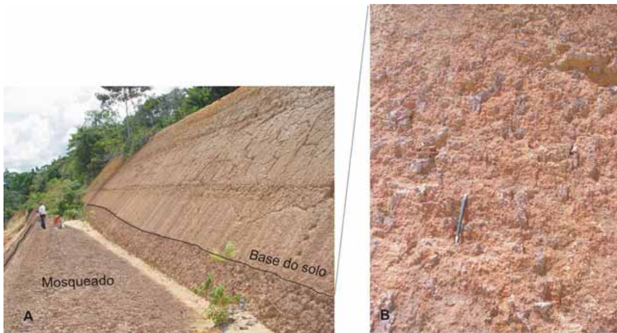
Figura 13 – Topo do perfil 1A. A – contato erosivo entre o mosqueado e o solo; B – detalhe do topo do horizonte mosqueado onde ocorrem as porções endurecidas na vertical.
