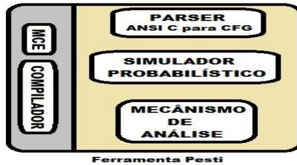
Figura 14 – Arquitetura da Ferramenta PESTI
