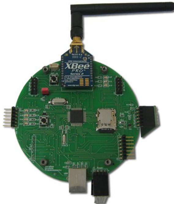
Figura 3.6 Placa Unidade Processamento e Armazenamento de Dados.
