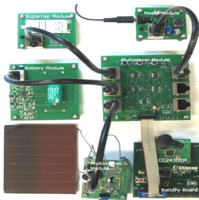
Figura 2.3 Arquitetura com Módulos de Energia.
