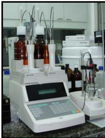
**Figura 14:** Titulador Potenciométrico Automático
