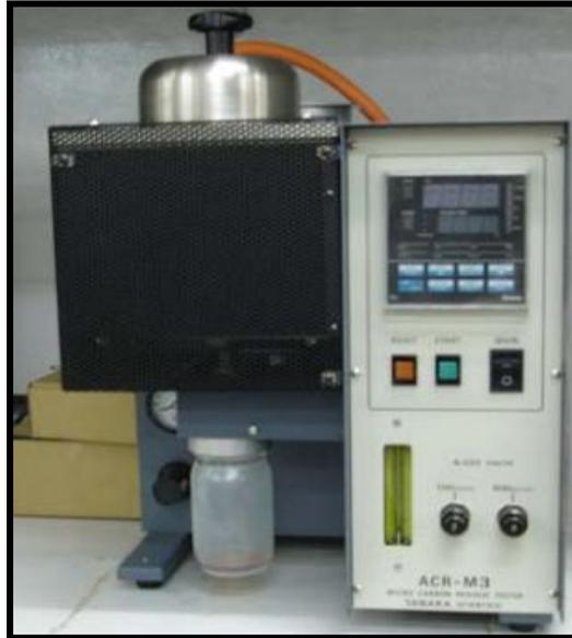
**Figura 15:** Equipamento de determinação do Resíduo de Carbono.
