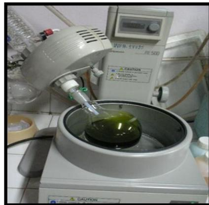
**Figura 7.** Evaporador rotativo
