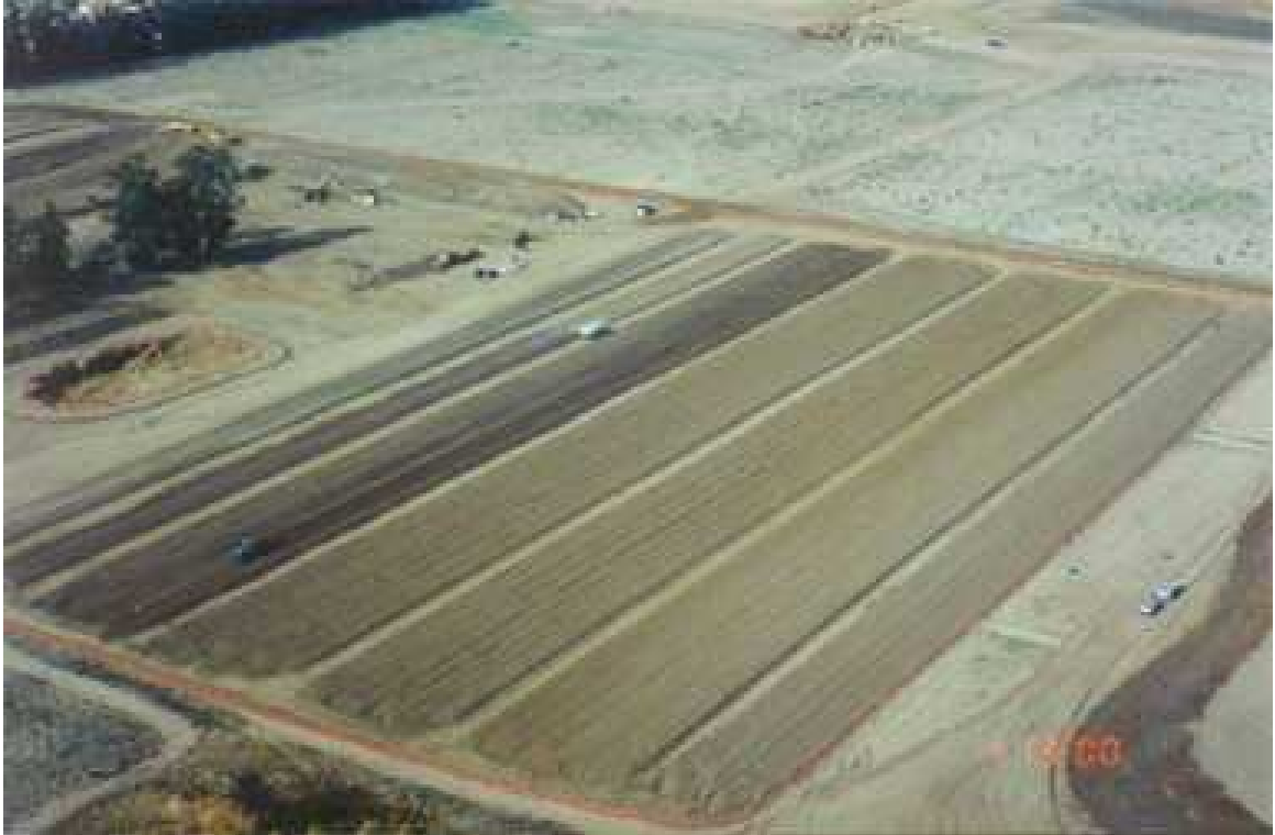
Figura 3. Vista de um sistema landfarming Fonte: Miliarium, 2008.
