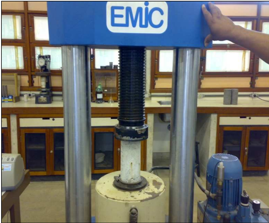
Figura 12. Máquina universal informatizada modelo EMIC DL 30000 para ensaio de resistência à compressão.
