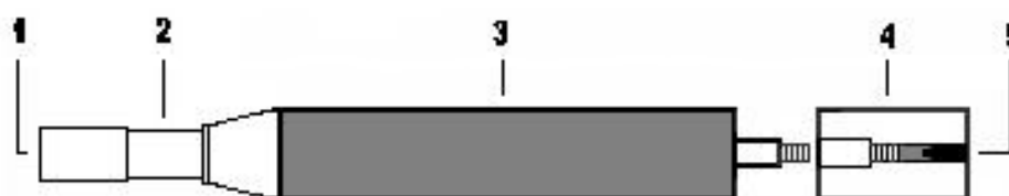
Figura 4. Esquema do eletrodo rotatório de Carbono Vítreo (CV): 1) Rosca para encaixe ao sistema rotatório; 2) Corpo de aço inoxidável; 3) Revestimento de teflon; 4) Revestimento do eletrodo em resina epóxi; 5) Eletrodo de trabalho (carbono vítreo).
