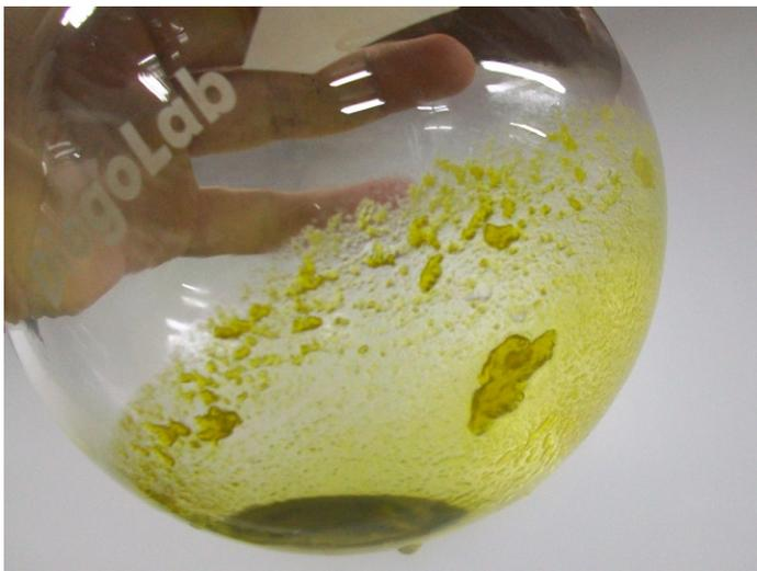
**Figura 16.** Formação de precipitado durante o processo de concentração do EHGC.
