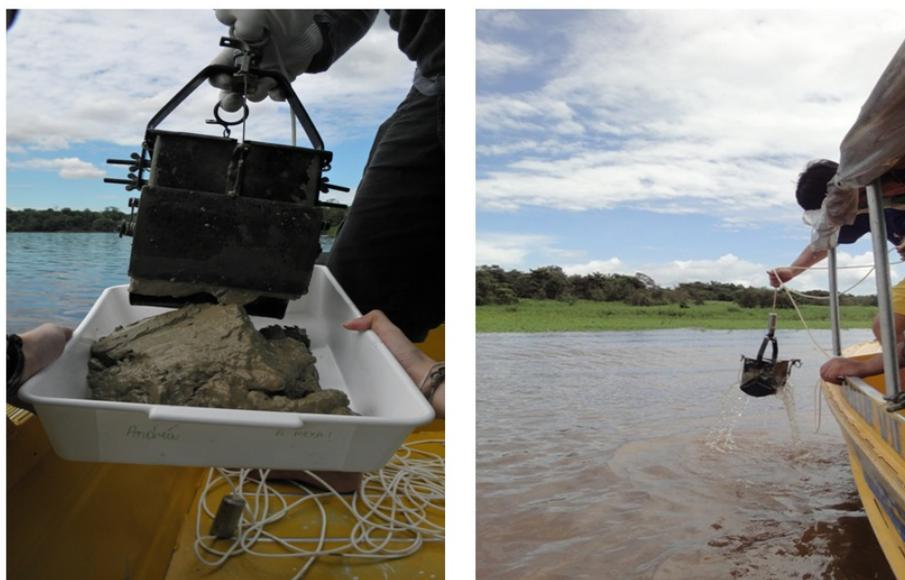
Figura 5.1: Coleta de sedimento de fundo com draga tipo Eckman.
