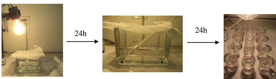
Esquema 16: Procedimento do teste de toxicidade com Artemia salina .
