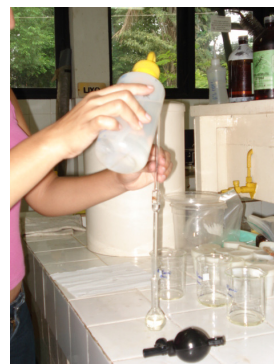
Figura 13 - Aferição com água deionizada FONTE: Arquivo pessoal ANA SOUSA, 2006.
