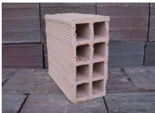
Figura 5 – Tijolo 9x19x19 “Padrão”
