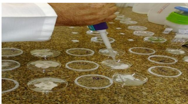
Figura 4. Adição de água na placa de Petri.
