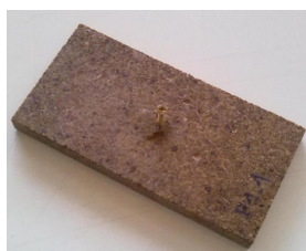
Figura 88 – Corpo-de-prova com parafuso fixado após o ensaio.
