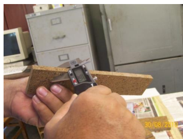
Figura 71 - Paquímetro com resolução de 0,1 mm, aferindo a espessura, com três pontos de medição no corpo-de-prova.
