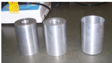
Figura 46 – Portas-amostra com diferentes dimensões, da esquerda para a direita: pequeno, micro e grande.
