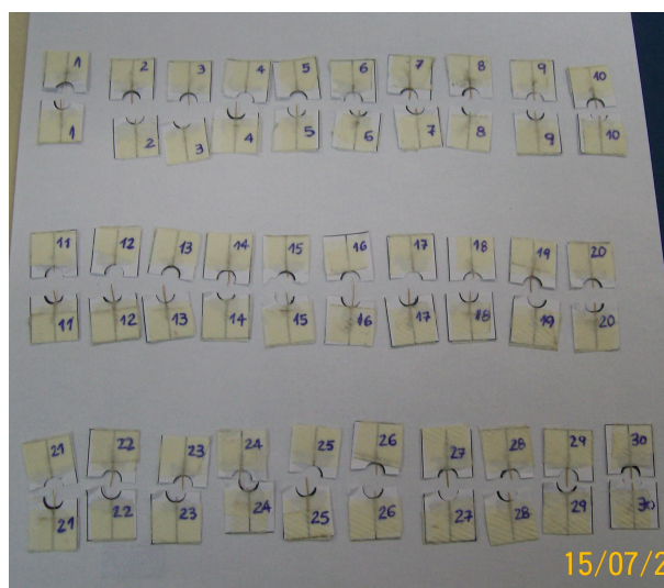
Figura 40 – Filamentos de fibra do açai após o ensaio de resistência à tração.
