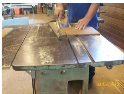
Figura 69 – (a) Corte dos corpos-de-prova. (b) Corpo-de-prova para ensaio físico e ensaio mecânico.
