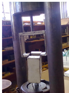
Figura 99 – Dispositivos colocados na máquina universal de ensaio..
