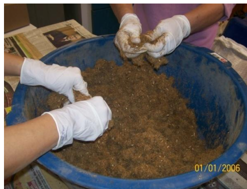
Figura 58 – (a) Mistura da fibra do açaí com o adesivo. (b) Homogeneização manual.
