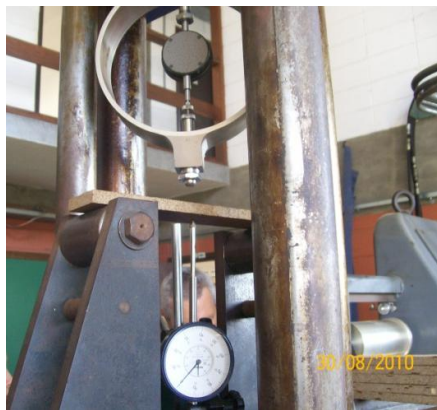
Figura 75 - O corpo-de-prova posicionado na máquina universal de ensaios.
