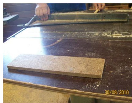
Figura 69 – (a) Corte dos corpos-de-prova. (b) Corpo-de-prova para ensaio físico e ensaio mecânico.
