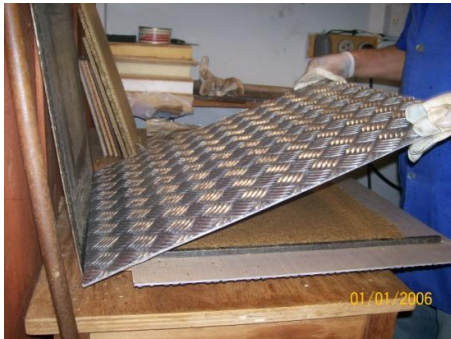
Figura 64 – (a) Retirada a bandeja metálica da prensa hidráulica parte superior. (b) Painel finalizado sobre a bandeja metálica, pronto para o período de cura.
