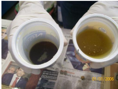
Figura 49 – Dois recipientes para colocar as resinas. À esquerda é o pré-polímero (derivado de petróleo). À direita o óleo a base de mamona (poliol).
