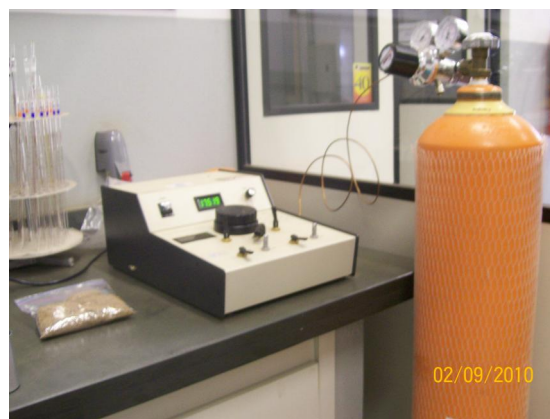
Figura 44 – (a) Picnômetro conectado ao cilindro de gás Hélio.
