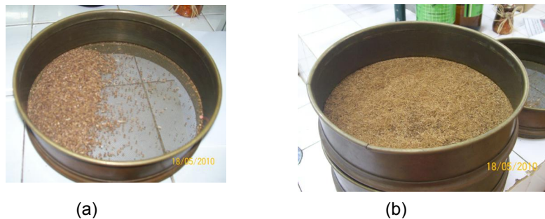
Figura 27 – (a) Na peneira de 20 Mesh ficou retida a casca (partículas maiores). (b) Na peneira de 40 Mesh e 60 Mesh ficaram as fibras.
