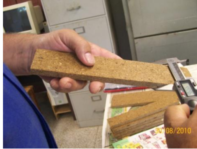
Figura 72 - Paquímetro com resolução de 0,1 mm, aferindo a largura, com três pontos de medição no corpo-de-prova.
