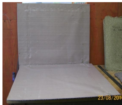
Figura 53 – Bandejas metálicas revestidas de material antiaderente: base superior e base inferior.
