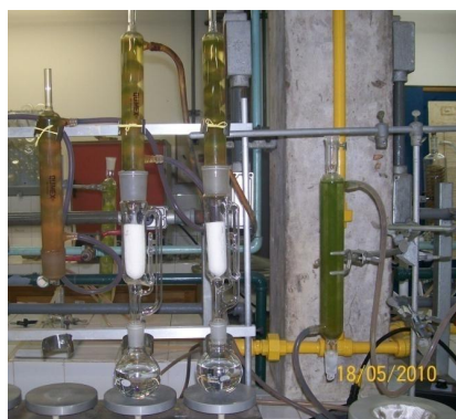
Figura 30 – Cartuchos de Celulose inseridos no extrator encaixado no balão de fundo chato.
