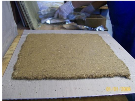
Figura 64 – (a) Retirada a bandeja metálica da prensa hidráulica parte superior. (b) Painel finalizado sobre a bandeja metálica, pronto para o período de cura.
