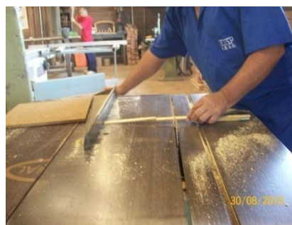
Figura 68 – (a) Retirado as aparas do painel preliminar. (b) Painel preliminar esquadrinhado e preparado para o corte dos corpos-de-prova.
