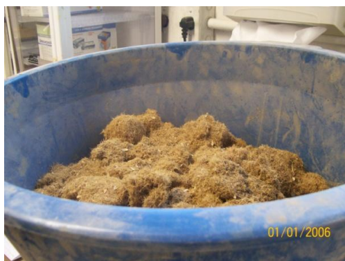
Figura 58 – (a) Mistura da fibra do açaí com o adesivo. (b) Homogeneização manual.
