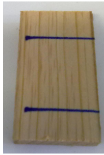
Figura 94 – Bloco de tração marcado para identificar o local de colagem.
