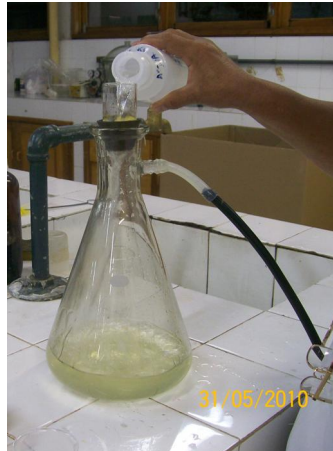
Figura 35 – Funil à vácuo, filtragem da amostra com água e etanol.
