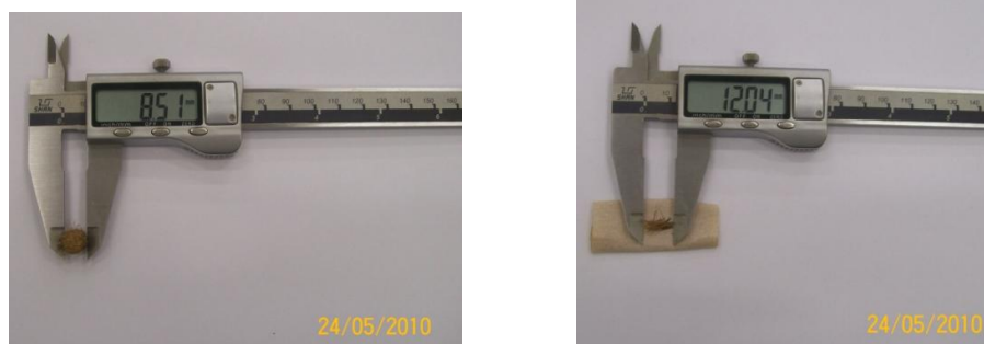
Figura 18 – (a) Medidas do diâmetro da semente. (b) Comprimento da fibra do açai.
