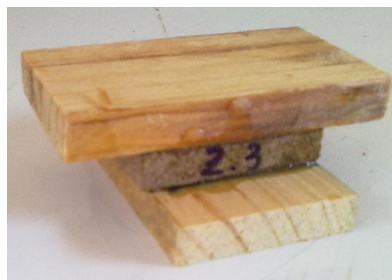
Figura 96 – Bloco de tração colado na parte inferior da superfície do corpo-de-prova e transversalmente na superfície superior.
