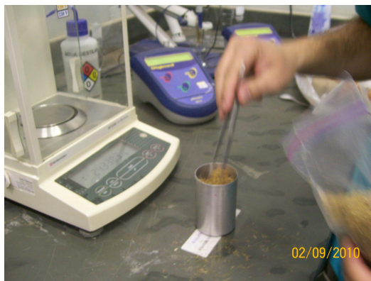
Figura 47 – Amostra sendo colocada com uma pinça no porta-amostra grande.
