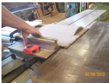
Figura 68 – (a) Retirado as aparas do painel preliminar. (b) Painel preliminar esquadrinhado e preparado para o corte dos corpos-de-prova.
