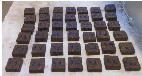
Figura 67 – Corpos de prova colocados sobre um pano para retirar o excesso de água.
