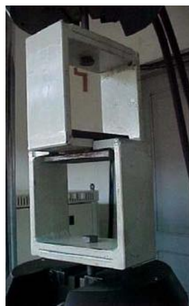
Figura 101 – Conjunto (blocos de tração e corpo-de-prova) acoplado nos dispositivos.
