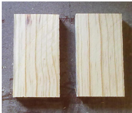
Figura 92 – Bloco de tração, parte superior e parte inferior.
