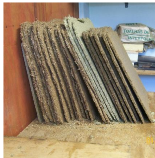
Figura 56 – Bancada para a cura dos painéis.
