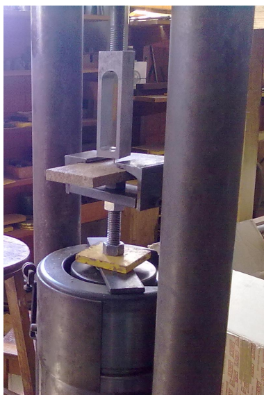
Figura 86 – Corpo-de-prova acoplado entre os dispositivos da máquina universal de ensaio: o dispositivo de fixar e o dispositivo para tracionar o parafuso.
