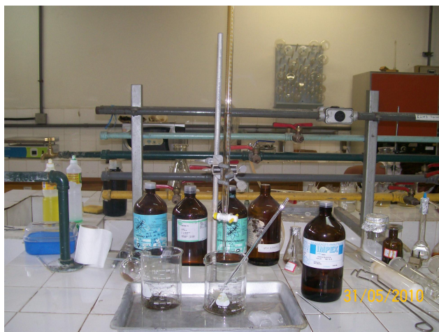
Figura 34 – Mistura da amostra em um béquer gotejando 15 ml de \text{H}_2\text{SO}_4 (72%).
