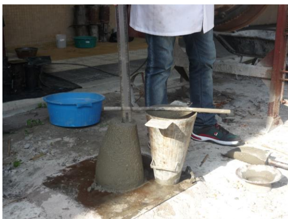
Figura 23 - Slump Test ( Laboratório da UFAM).
