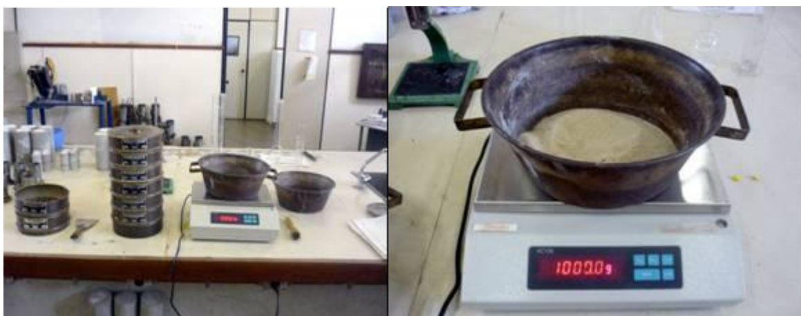
Figura 12 - Ensaio de granulometria pela NBR 7217/1987.
