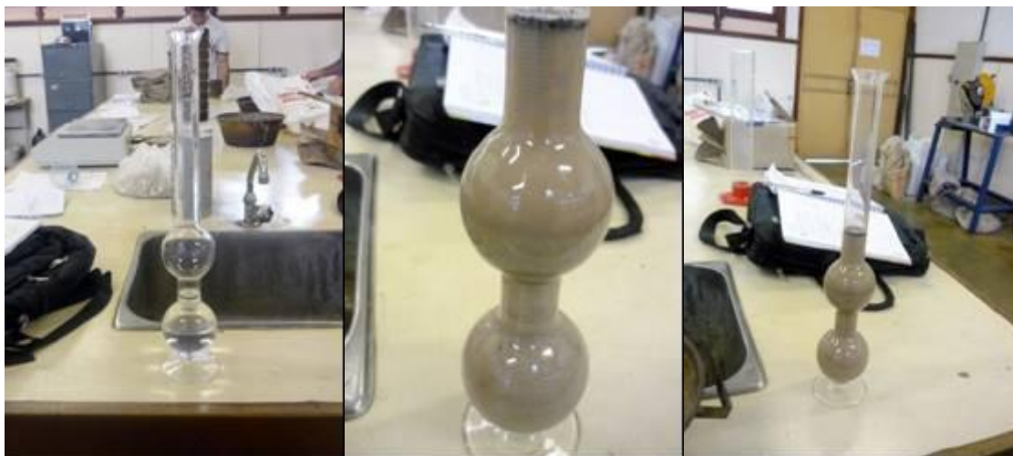
Figura 15. Determinação da massa específica real da areia pela NBR 9776-1987.
