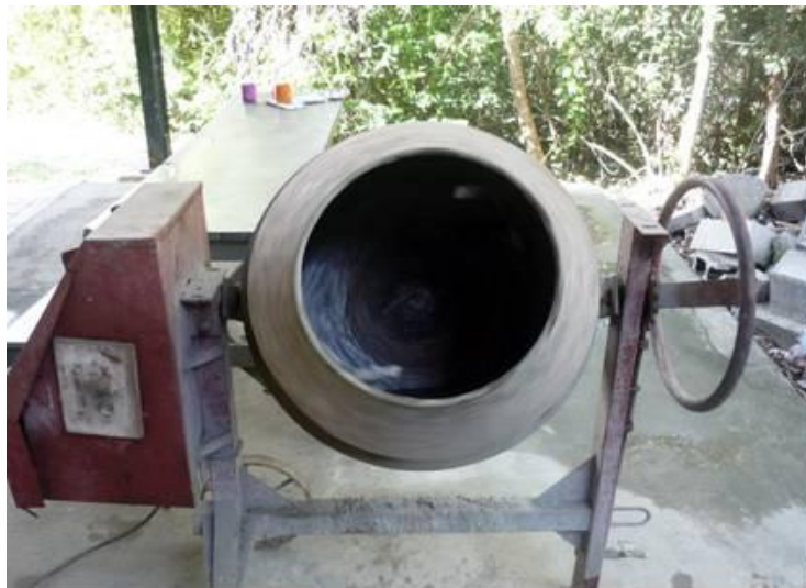
Figura 21 - Betoneira de eixo inclinado com capacidade de 120 litros.
