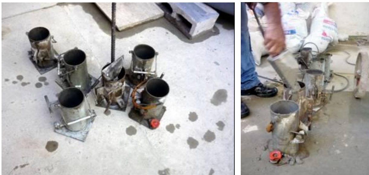
Figura 24 - Moldagem dos corpos de prova.
