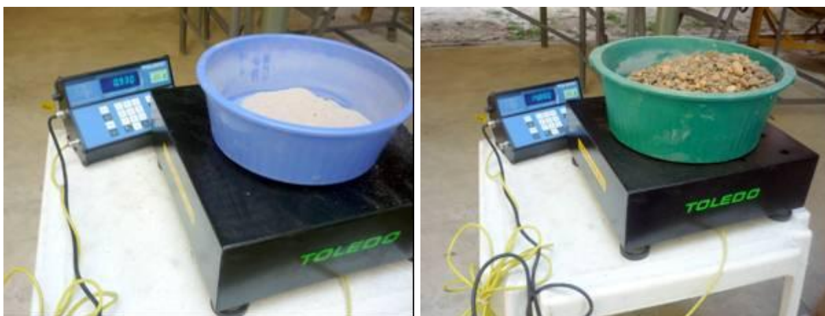
Figura 18 - Pesagem dos materiais para a dosagem do concreto convencional.
