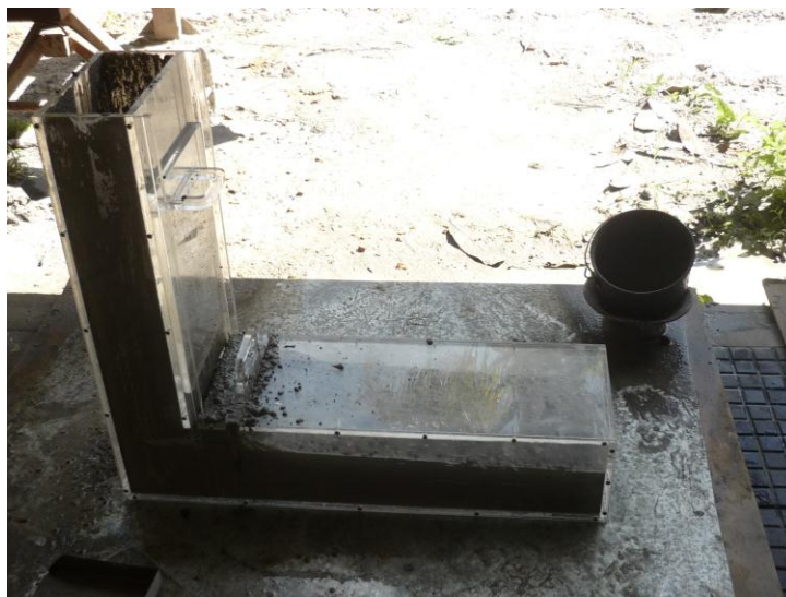
Figura 28 - Ensaio de habilidade de passante do L-Box test .
