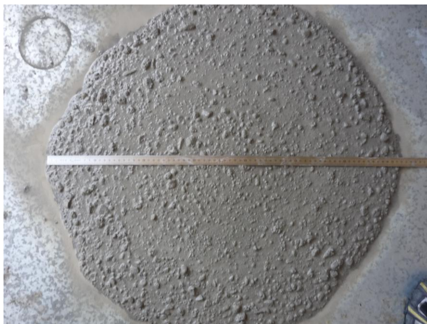
Figura 26 – Medição de um dos diâmetros no Ensaio de Fluidez do Slump Flow.
