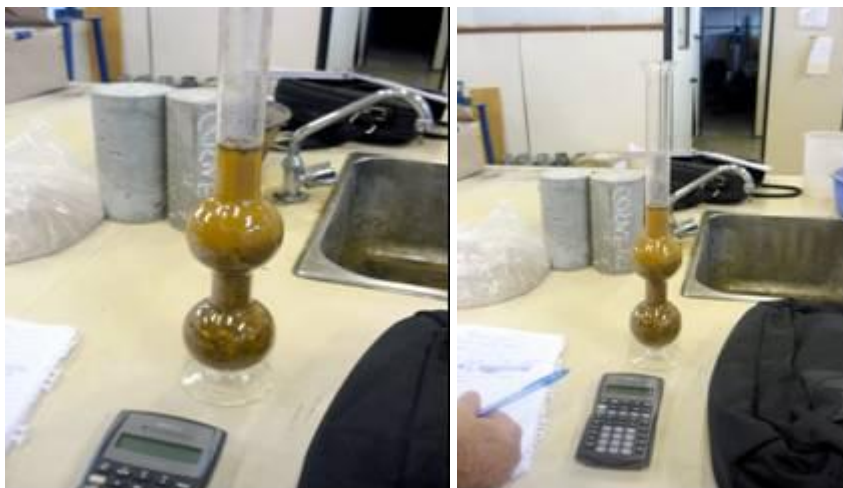
Figura 16 - Determinação da massa específica real do seixo pela NBR 9937-1987
