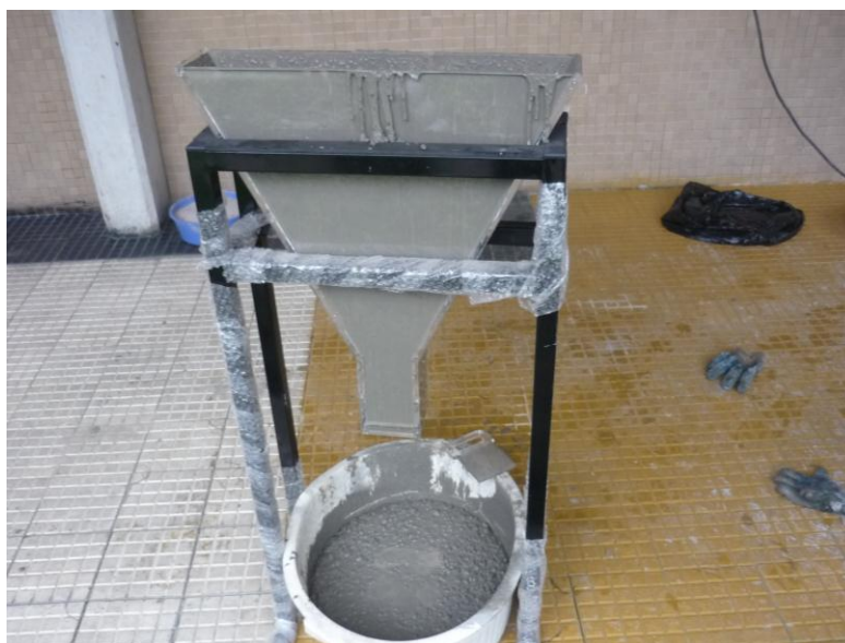
Figura 27 - Ensaio de viscosidade plástica aparente do V-funil test.
