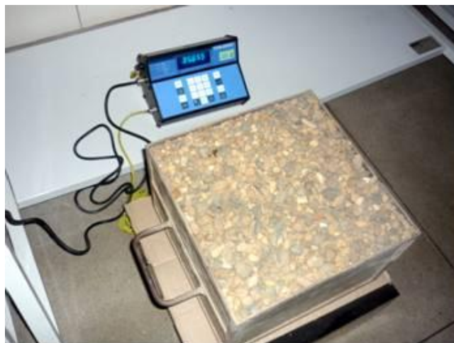
Figura 11 - Determinação da massa unitária do seixo pela NBR 7251/1982.
