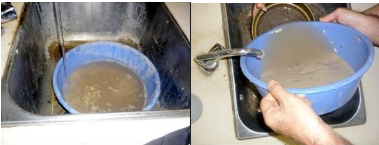
Figura 14 - Determinação do teor de material pulverulento pela NBR 7219-1987.
