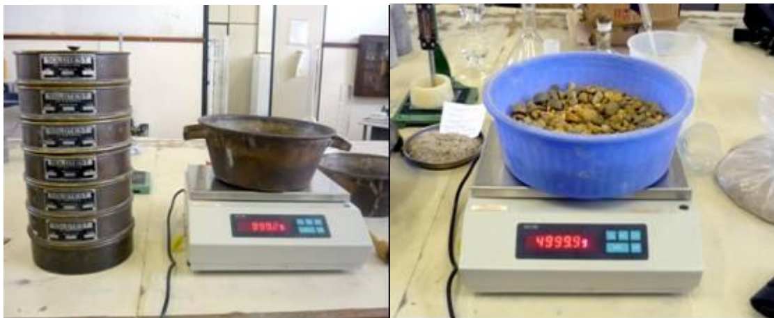
Figura 13 - Ensaio de granulometria pela NBR 7217/1987.
