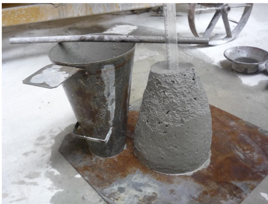
Figura 34 – Ensaio do Slump test com abatimento de 62 mm.
