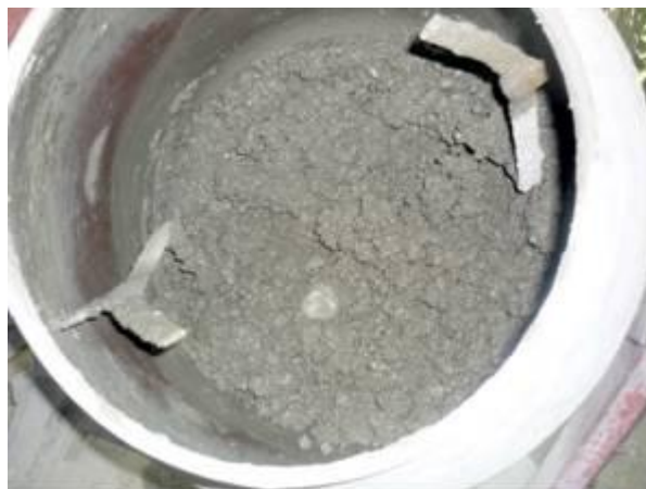
Figura 22 - Concreto convencional após 5 minutos de mistura.
