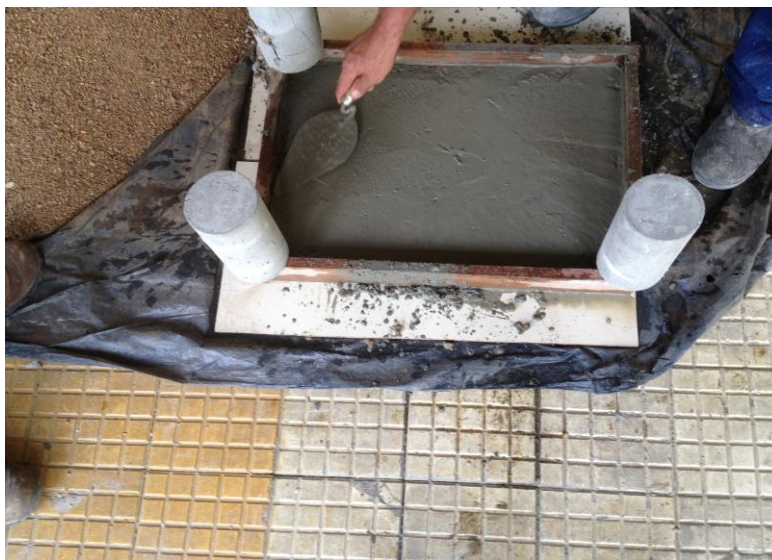
Figura 29 – Preparo da placa de concreto de 39 x 65 x 5cm.
