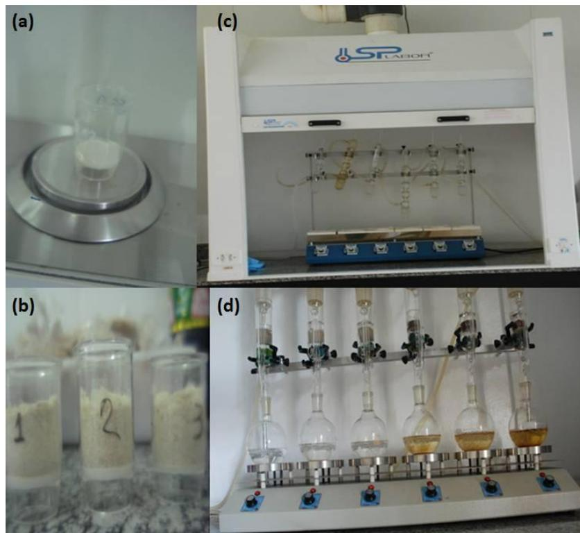
Figura 30 - (a) Cadinho poroso nº2; (b) Cadinhos com amostras do material; (c) Capela de exaustão de gases; (d) Sistema montado: balão volumétrico de fundo chato, soxhlet e condensador e chapa aquecedora.
