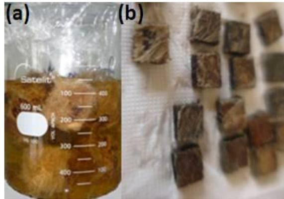
Figura 52 - (a) Amostras submersas; (b) Remoção do excesso de água das amostras.
