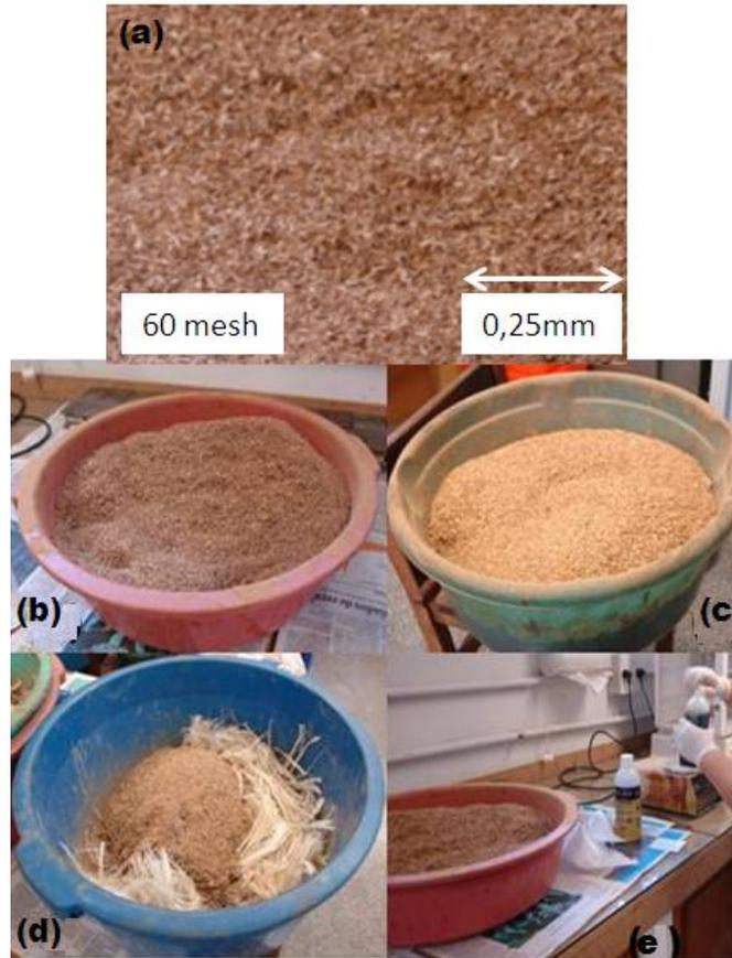
Figura 47 –(a) Granulometria dos resíduos; (b) Resíduo de amapá-doce; (c) Resíduo de louro-inhamuí; (d) Resíduo de madeiras com fibras; (e) Resinas pesadas para serem adicionadas nas amostras.
