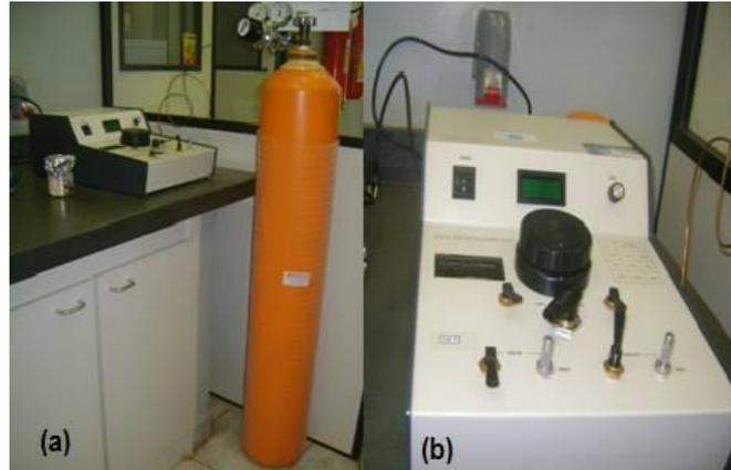
Figura 39– (a) Picnômetro conectado ao cilindro de gás Hélio; (b) Picnômetro.
