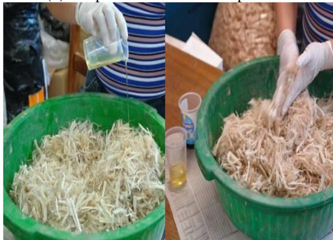
Figura 46 - Mistura das fibras cortadas com as resinas.
