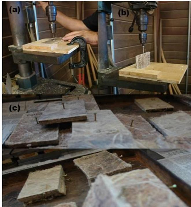
Figura 55 – (a) Parafuso sendo colocado na face; (b) Parafuso sendo colocado no topo; (c) Amostras com parafusos.
