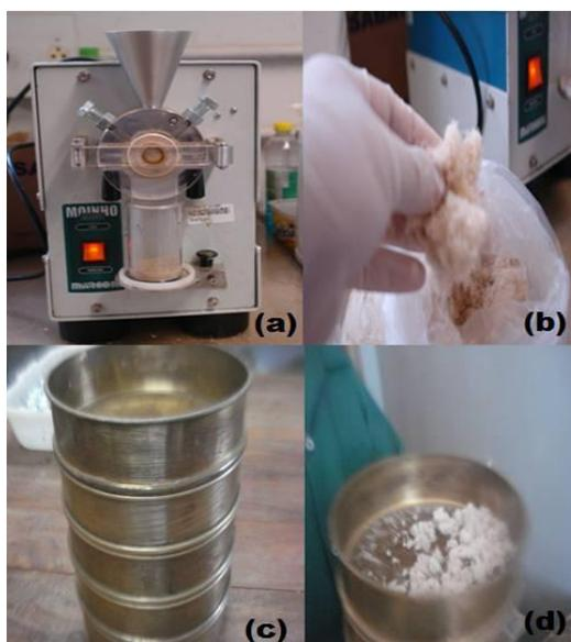
Figura 27 – (a) Moinho para triturar a fibra; (b) fibras moídas; (c,d) peneiras com os materiais retidos.
