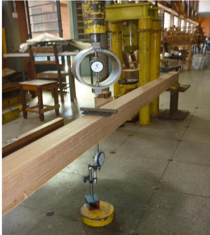
**Figura 41:** Ensaio de flexão na viga de madeira.
