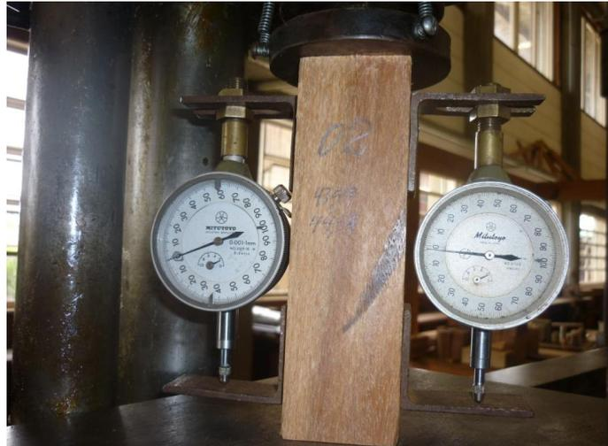
Figura 38: Corpo de prova para o ensaio de compressão paralela às fibras.
