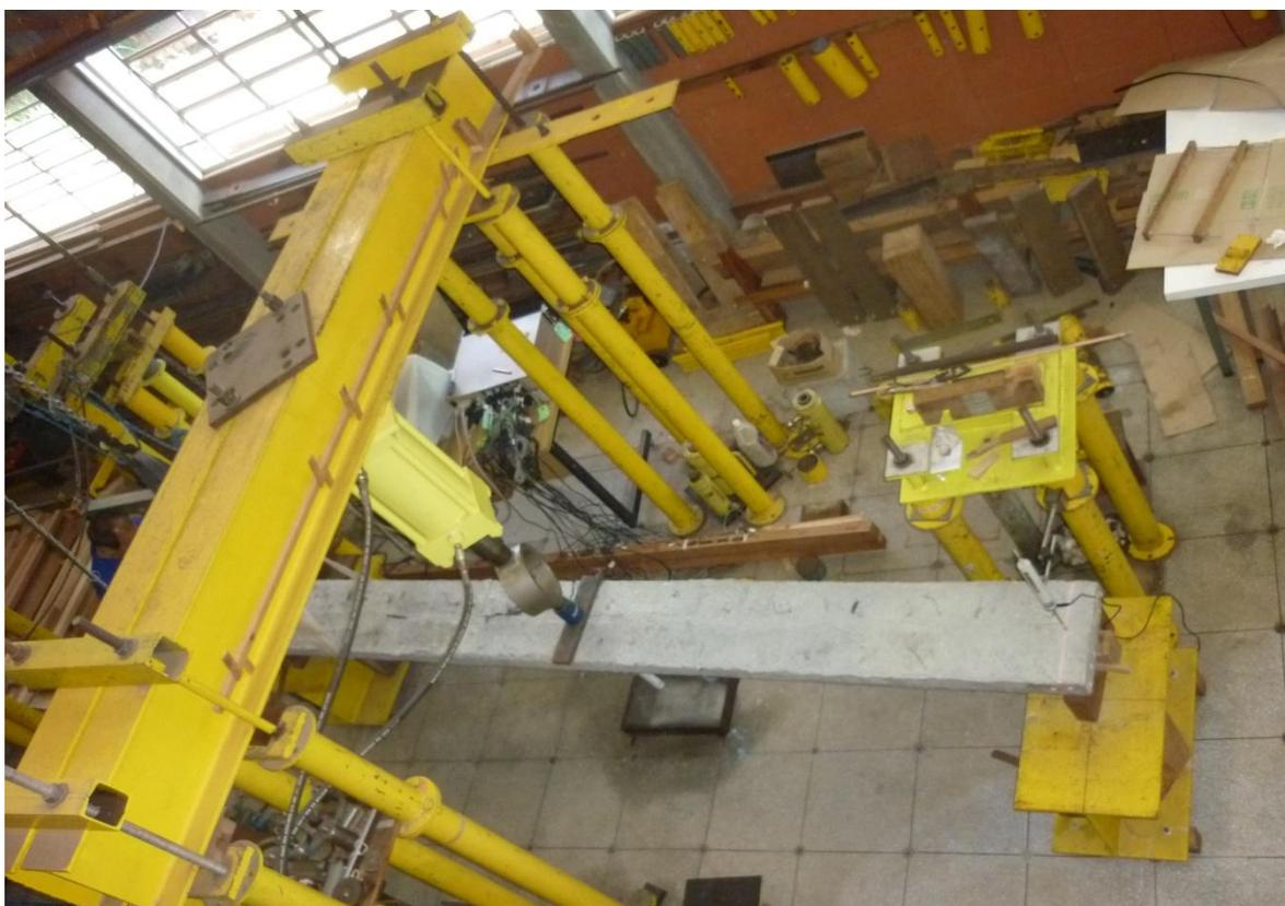
**Figura 55:** Pórtico de reação com cilindro hidráulico.
