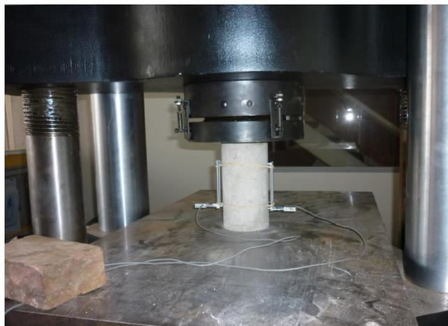
**Figura 42:** Detalhes do ensaio de caracterização do concreto.
