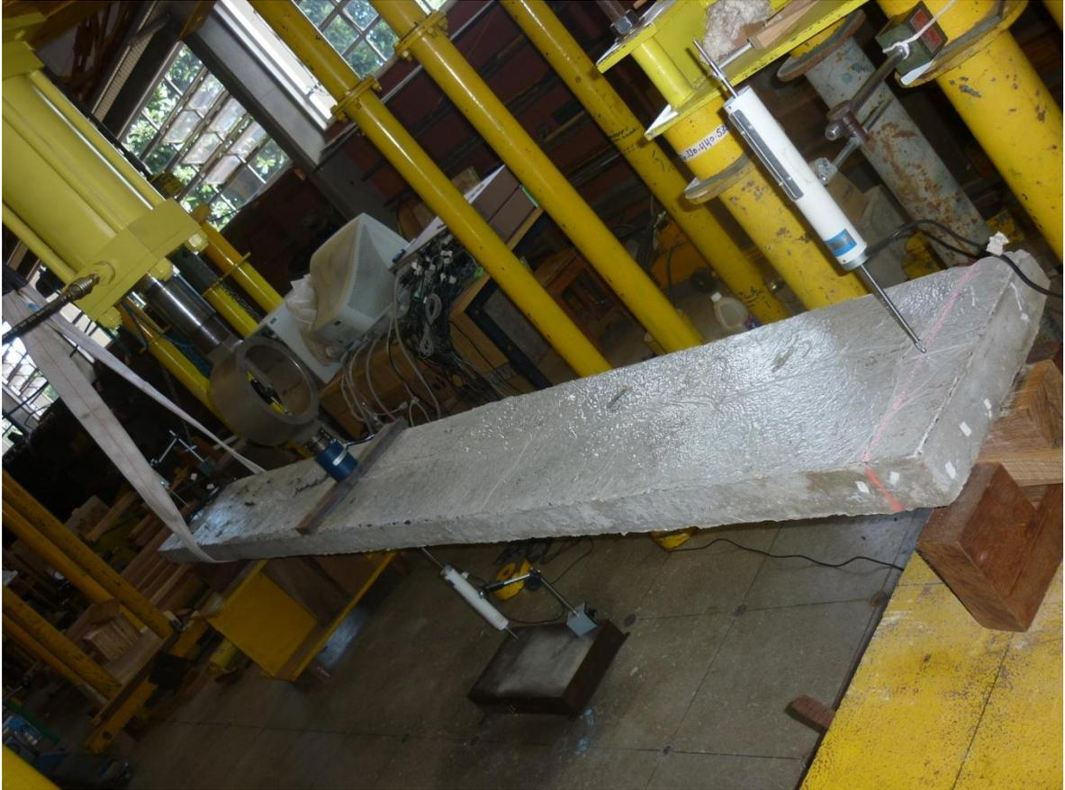
**Figura 56:** Ensaio de flexão da Viga Mista.
