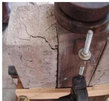
**Figura 29:** Detalhe das fissuras no corpo de prova – CP2.
