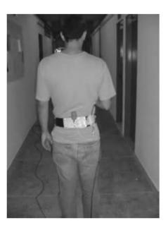
Figura III.6 – Indivíduo caminhando com um acelerômetro acoplado em seu centro de gravidade aproximado (Fonte: Silva e Pimentel, 2011)
