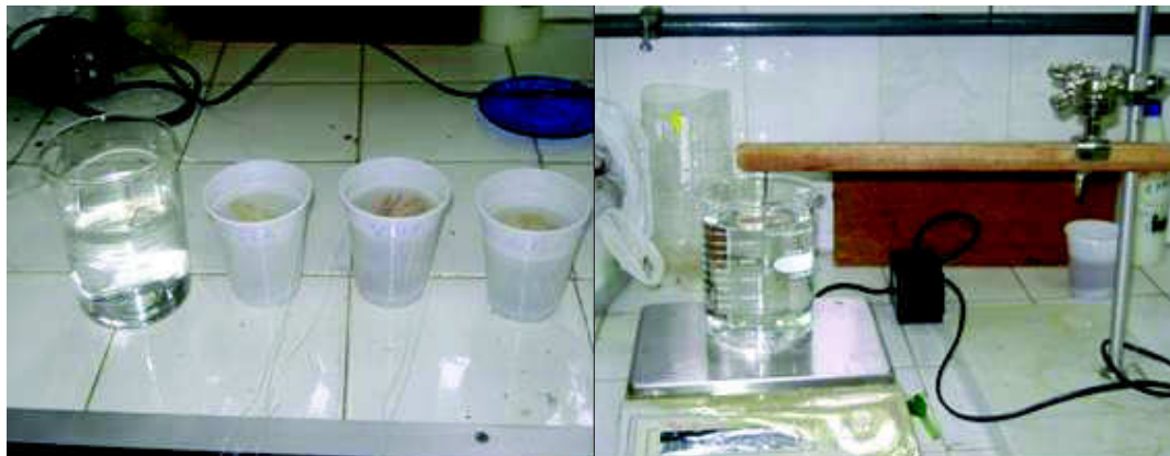
Figura 22. Determinação do volume de água deslocada pela fibra de arumã .
