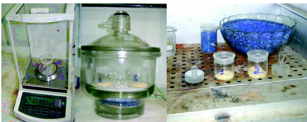
Figura A6c. Pesagem da fibra vegetal de arumã após secagem em estufa e passagem pelo dessecador.
