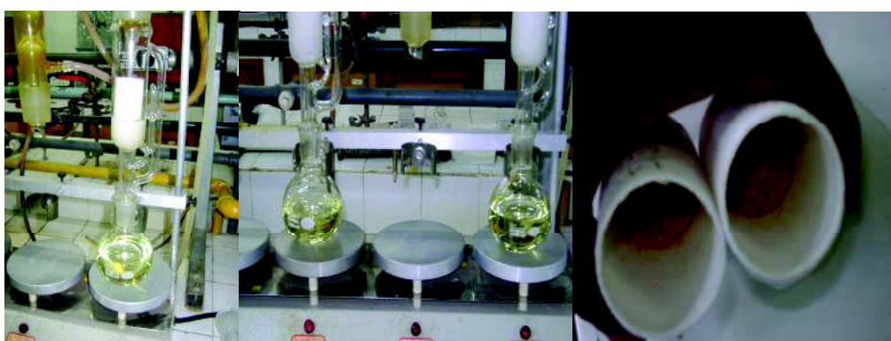
Figura A6g. Finalização da extração. Cartucho de celulose com a amostra da fibra vegetal de arumã , após o término da extração.
