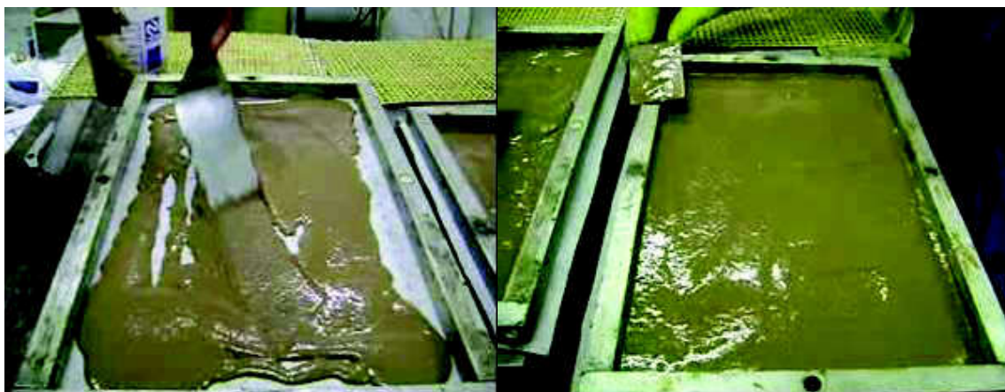
Figura 34. Primeira camada de argamassa.
