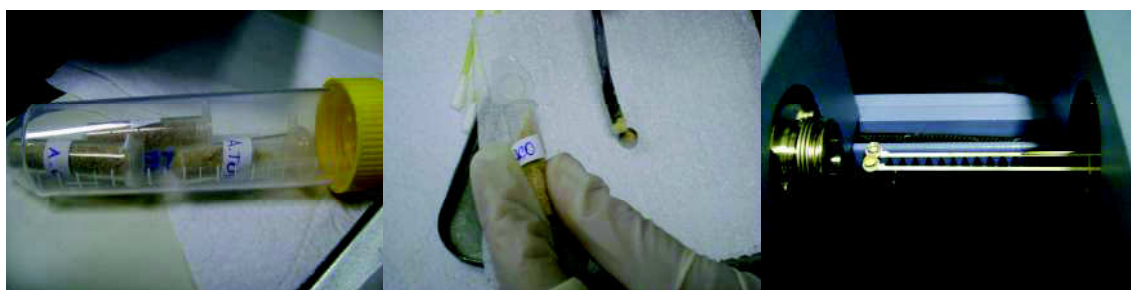
Figura A5b. Introdução da amostra no equipamento TA STD Q600 V20.5.
