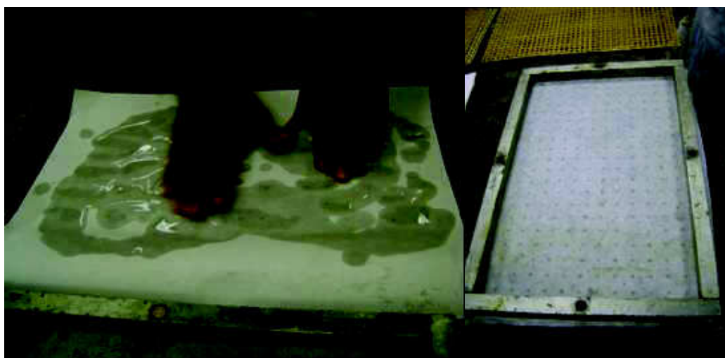
Figura 33. Fôrma de aço sendo forrada com filtro de papel.
