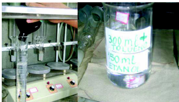
Figura A6d. Dosagem para a extração etanol-tolueno.
