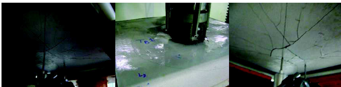
Figura A4g. Vista da superfície inferior e superior da placa, com a formação de acentuado número de fissuras em forma concêntrica, durante o carregamento de cargas, onde o elemento de reforço resiste ao esforço, impedindo a ruptura abrupta da placa.
