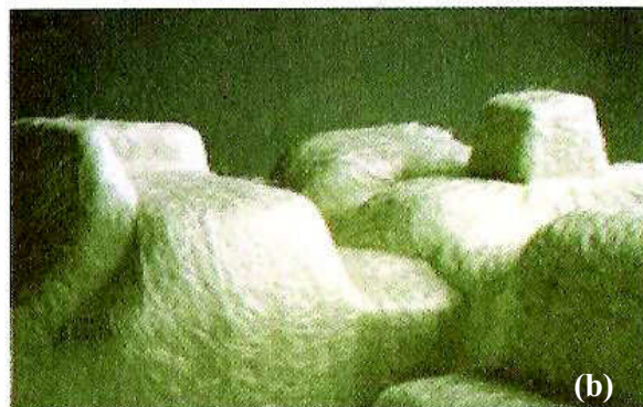
Figura 17. Fibras arranjadas em pré-formas, com (a) fibras longas e (b) fibras curtas.
