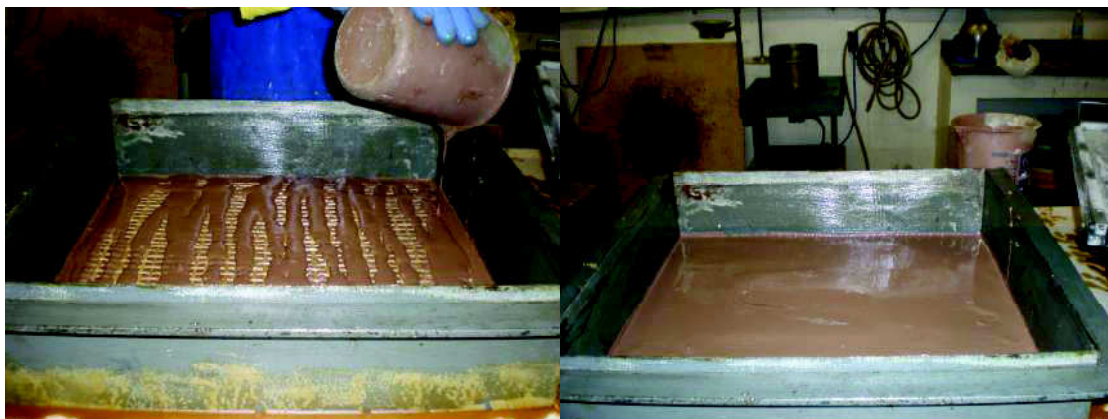
Figura 46. Acomodações na forma da tela de arumã e da camada de argamassa.
