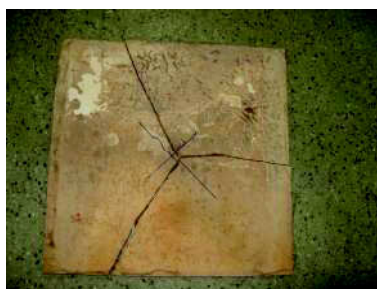
Figura A4d. Distribuição das fissuras na placa sem reforço..
