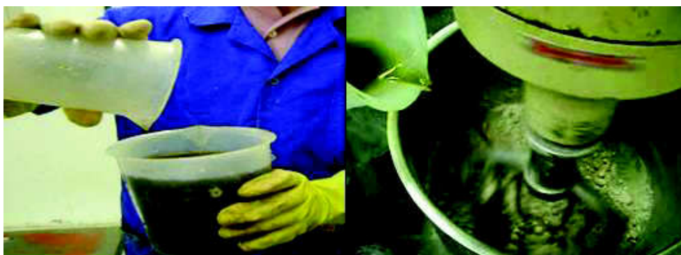
Figura 32. Diluição do superplastificante em água, sendo em seguida adicionado a mistura.
