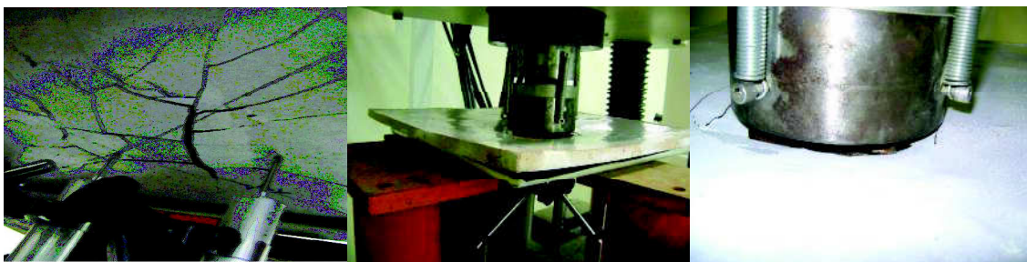
Figura A4h. No final do ensaio, observa-se o número de fissuras, sem a ocorrência da ruptura total da placa, mantendo a matriz ainda unida pelo elemento de reforço (tela de fibra vegetal de arumã ).
