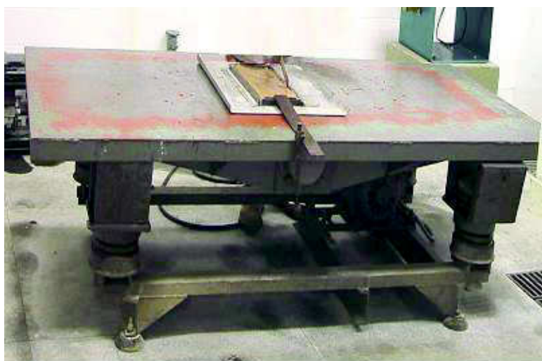
Figura 39. Compósito sendo vibrado.
