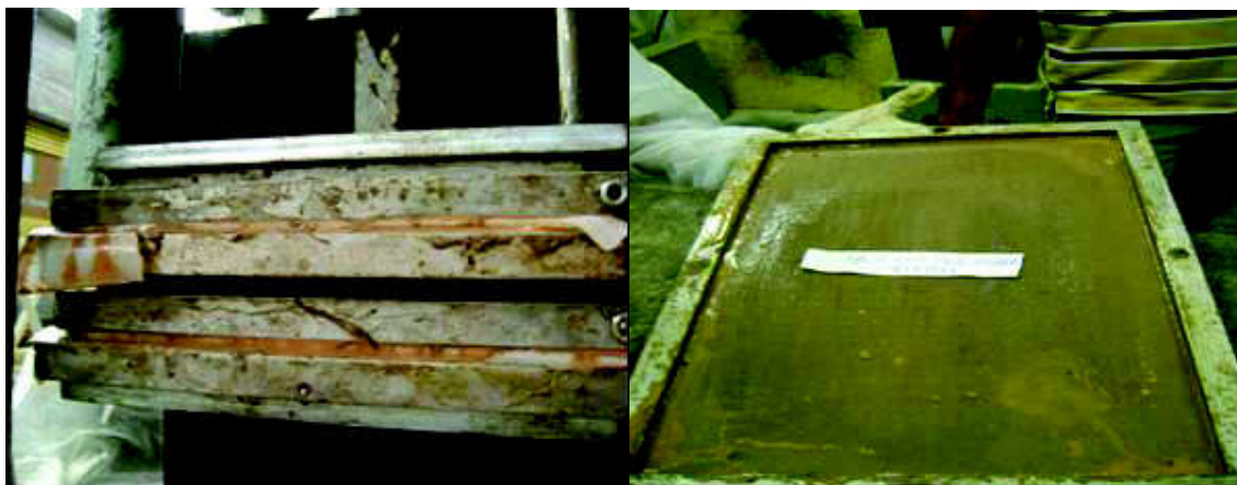
Figura 42. Laminados compósitos recebendo carregamento de pressão e compósito prensado.
