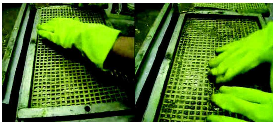
Figura 35. Segunda camada, arranjo da tela de arumã no molde.
