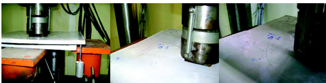
Figura A4f. Vista da superfície superior da placa, com fissuras em forma concêntrica, durante o carregamento.
