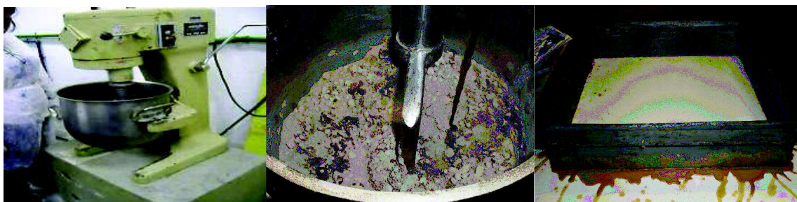
Figura A3a. Preparo da argamassa para confecção da placa cimentícia .
