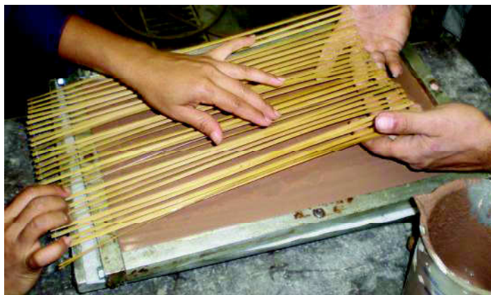
Figura 13. Representação de tecido quase unidirecional.
