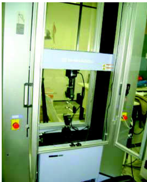
Figura 24. Ensaio para determinação do módulo de elasticidade da fibra de arumã .
