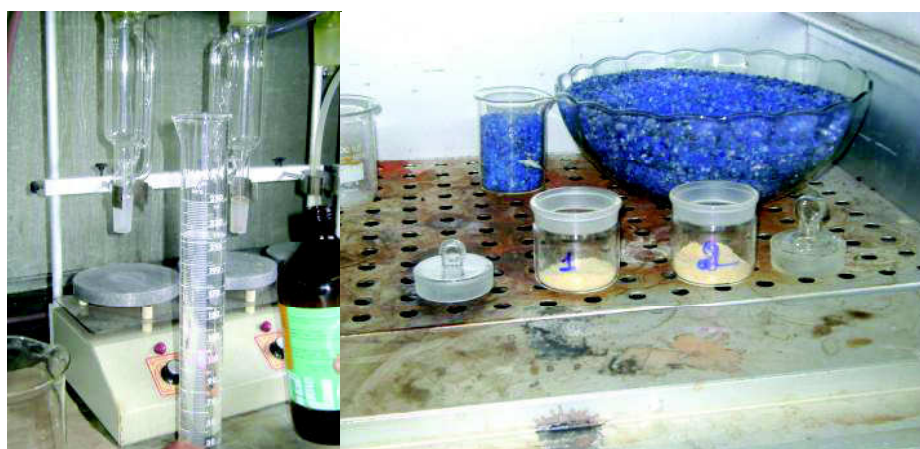
Figura 29 – Lavagem das amostras com álcool, e em seguida levadas para estufa 103^{\circ}\text{C} \pm 2^{\circ}\text{C} .
