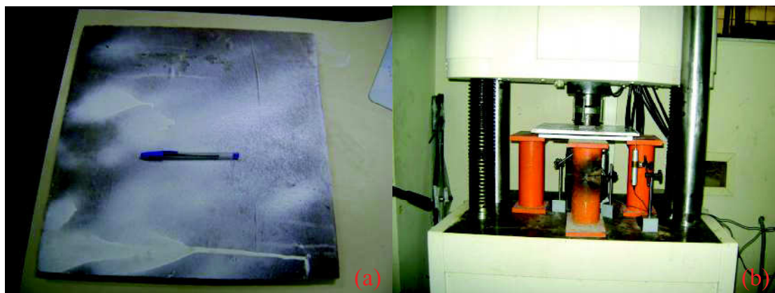
Figura 54. Ensaio de flexão em placas planas simplesmente apoiadas com carregamento central: (a) Placa de laminado pintada; (b) Iniciação do carregamento central.
