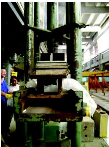
Figura 40. Atuador servo-hidráulico utilizado na prensagem do compósito.
