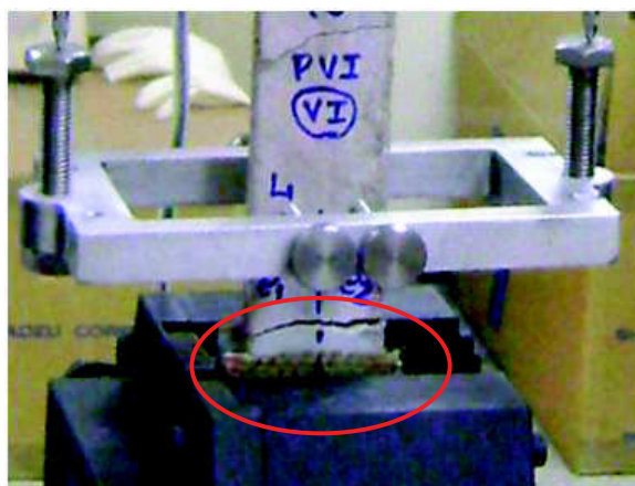
Figura 49. Laminados com placas de alumínio coladas e revestidas com juta em suas extremidades.
