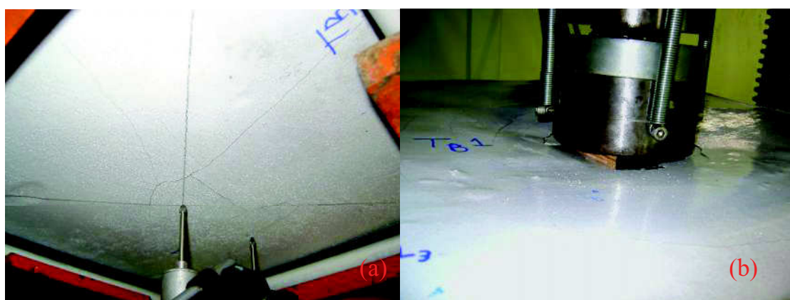
Figura 55. Ensaio de flexão em placas planas simplesmente apoiadas com carregamento central : (a) Aparecimento das fissuras – superfície inferior da placa; (b) Fissuras cocêntricas – superfície superior da placa.
