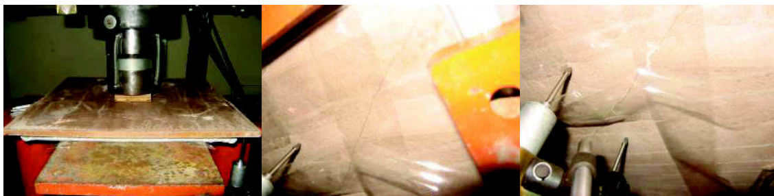
Figura A4c. Vista da superfície superior e inferior da placa, com o surgimento de fissuras radiais, atingindo até a extremidade da placa (placa sem reforço).
