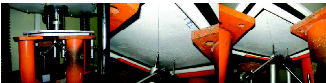
Figura A4b. Vista da superfície inferior da placa, com o surgimento de fissuras em forma radial (placa sem reforço).
