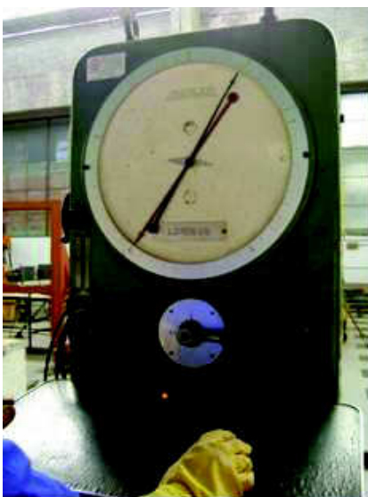
Figura 41. Relógio medidor de pressão de moldagem.
