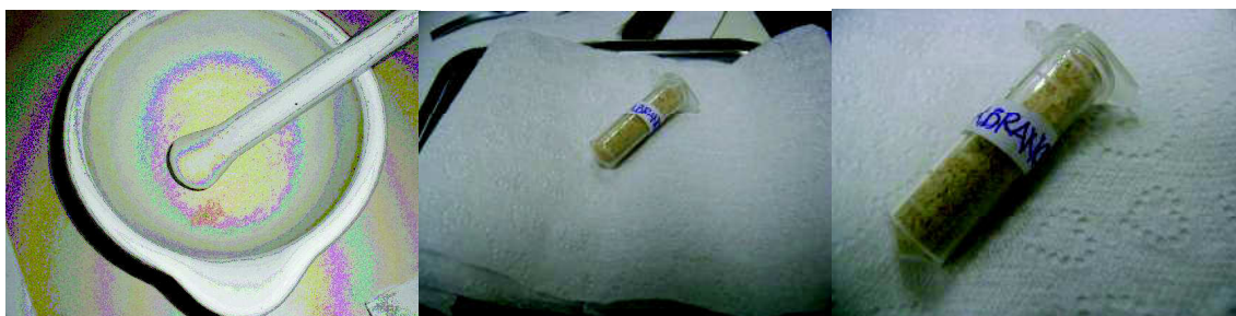
Figura A5a. Emaceração da amostra da fibra vegetal de arumã para ensaio de termogravimetria.
