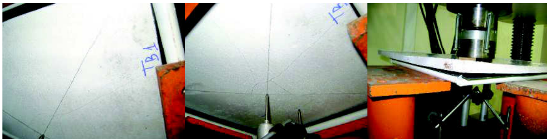
Figura A4e. Vista da superfície inferior da placa, com o surgimento de pequenas fissuras em forma concêntrica, com seus bordos levemente levantados (placa reforçada com fibra vegetal de arumã ).
