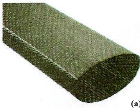
Figura 17. Fibras arranjadas em pré-formas, com (a) fibras longas e (b) fibras curtas.
