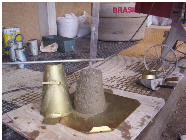
Figura 3.8 – Abatimento do concreto.
