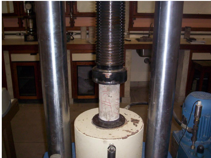
Figura 3.14 – Ensaio de resistência à compressão.
