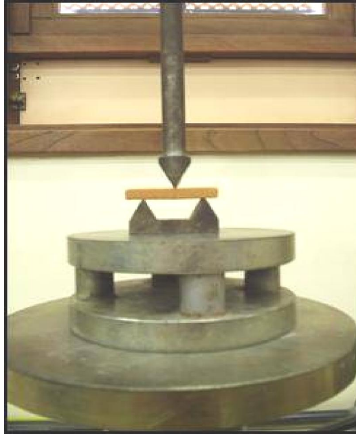
Figura 3.5 – Prensa elétrica para ruptura dos corpos-de-prova.
