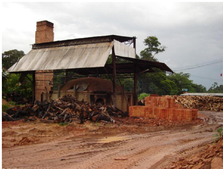
Figura 5.1 – Forno usado para queima dos produtos tijolos.
