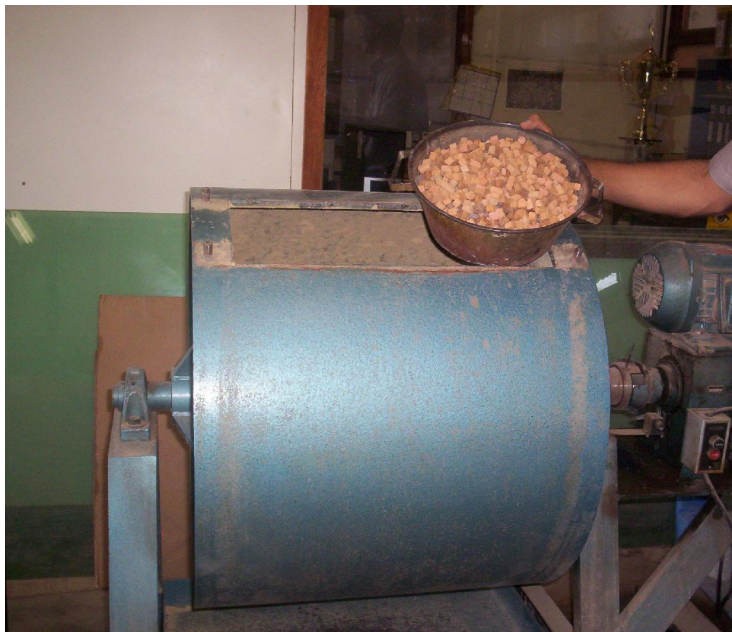
Figura 3.6 – Máquina de abrasão “Los Angeles”.
