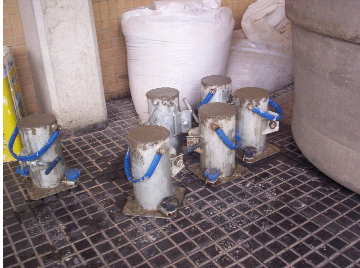
Figura 3.10 – Moldagem dos corpos-de-prova.
