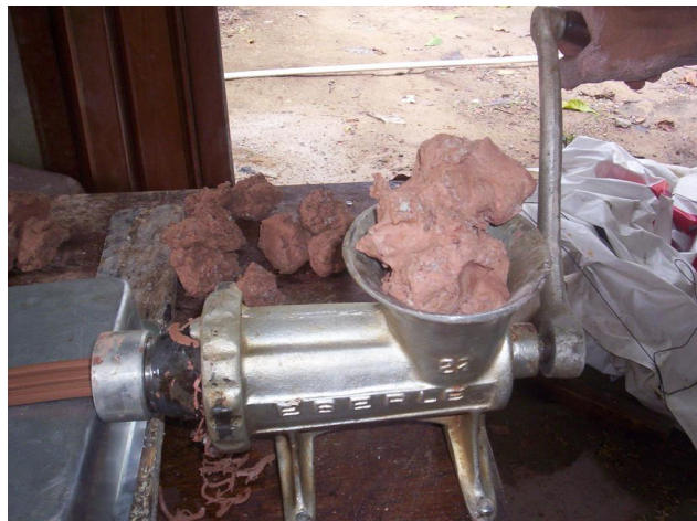
Figura 5.3 – Moinho para extrusão da matéria-prima.
