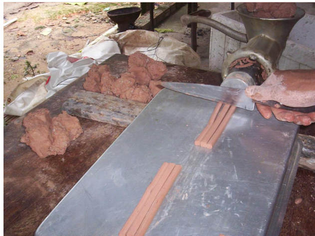
Figura 5.4 – Corte das barras moldados para a secagem.
