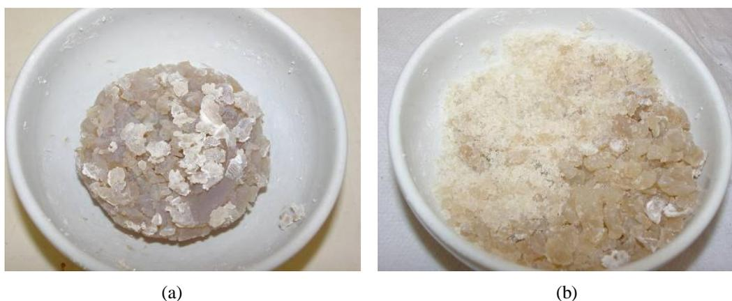
Figura 4.4 – (a) Gel do silicato oxidado (em processo de secagem), (b) Gel do silicato oxidado (desintegrado).
