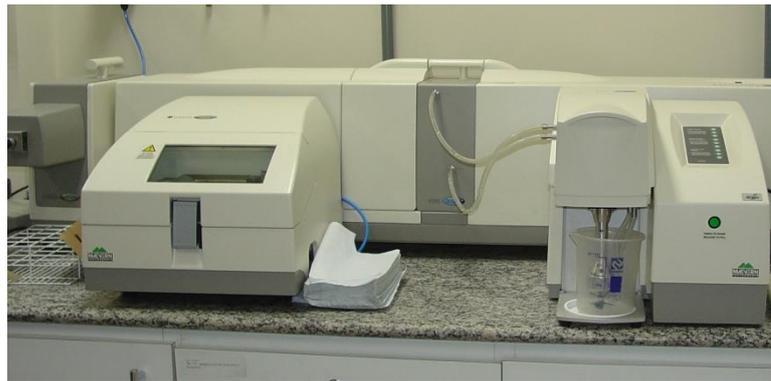
Figura 3.8 – Granulômetro a laser.
