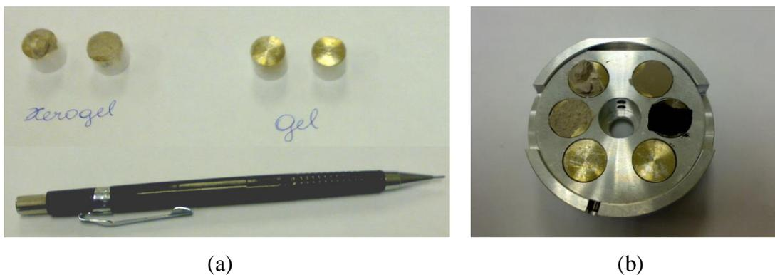
Figura 3.27 - Porta-amostras cilíndricos (a) e fixador metálico (b).
