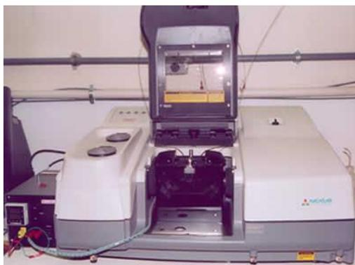
Figura 3.17 – Espectrômetro de Infravermelho.
