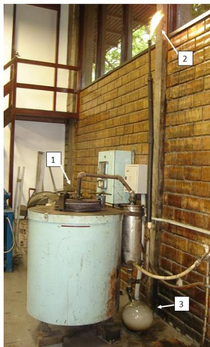
Figura 3.4 - Canalização dos gases pela tampa do cadinho (1) com condensação dos gases pesados (2) e queima dos gases leves (3).
