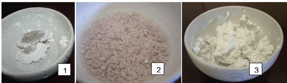
Figura 4.10 – Sílicas xerogéis obtidas após o processo de secagem.
