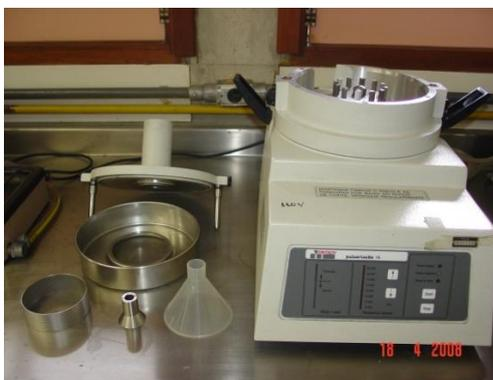
Figura 3.5 - Pulverizador para desintegração do carvão da casca de arroz.
