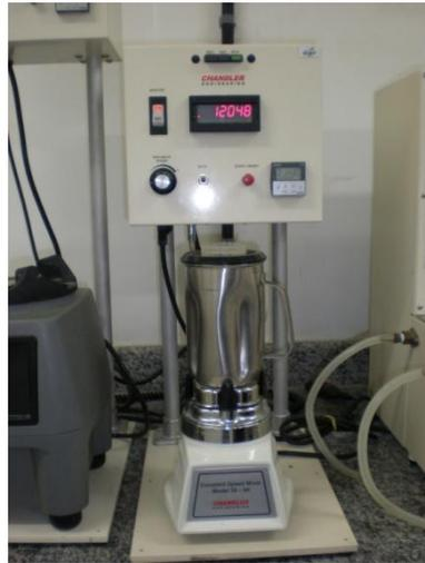
Figura 3.33 – Misturador mecânico.
