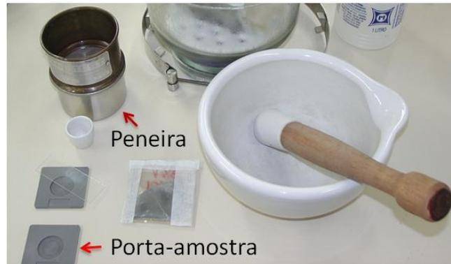
Figura 3.41 – Materiais empregados para a manipulação da amostra utilizada no ensaio de raios X.
