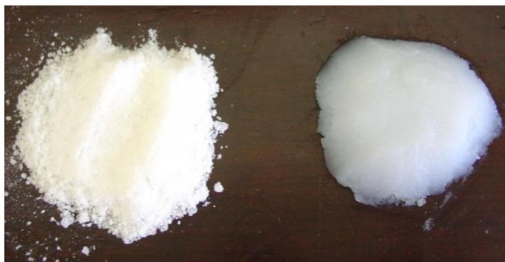
Figura 4.13 - Amostra com teor de umidade reduzido com etanol (à esquerda) e gel com elevado teor de umidade (à direita).
