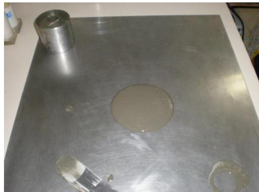
Figura 3.36 – Espalhamento de 10 cm da pasta 1 com sílica gel.
