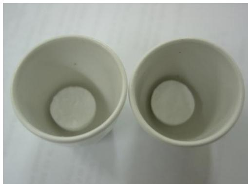
Figura 3.31 – Amostras de sílica xerogel, após o ensaio de perda ao fogo.
