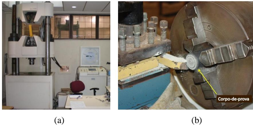
Figura 3.37 – Prensa Shimadzu (a) e faceamento (b).
