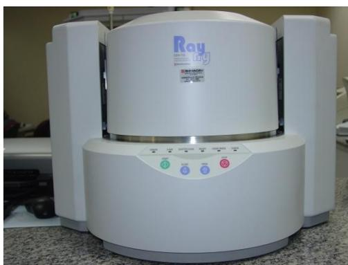
Figura 3.20 – Espectrômetro de Fluorescência de Raios-X.
