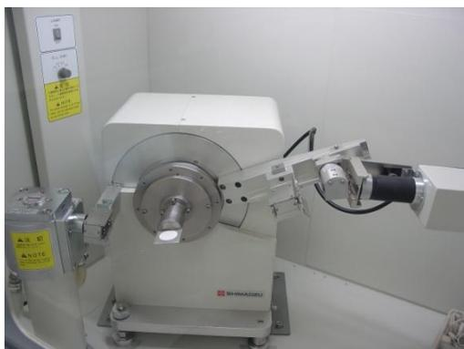
Figura 3.25 - Aparelho de difração em funcionamento durante o ensaio.
