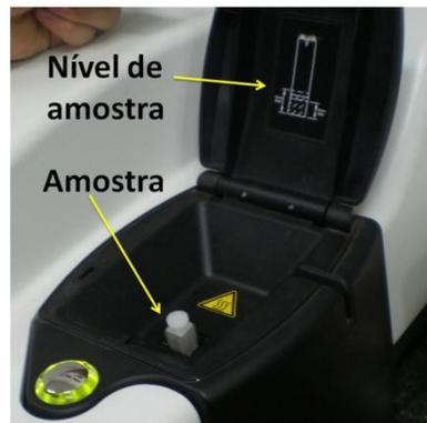
Figura 3.22 – Amostra dentro do analisador de partícula.
