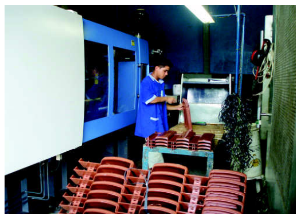
Figura 39 - Acabamento da telha.
