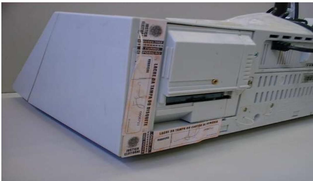
Figura 7 - Urna com as tampas do *driver* do disquete e do leitor de *flash card* lacradas.
