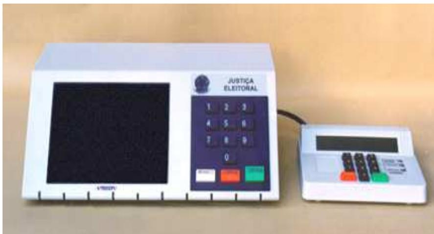
Figura 1- A Urna Eletrônica: Terminal do eleitor, à esquerda, e ligado a ele, o microterminal.
