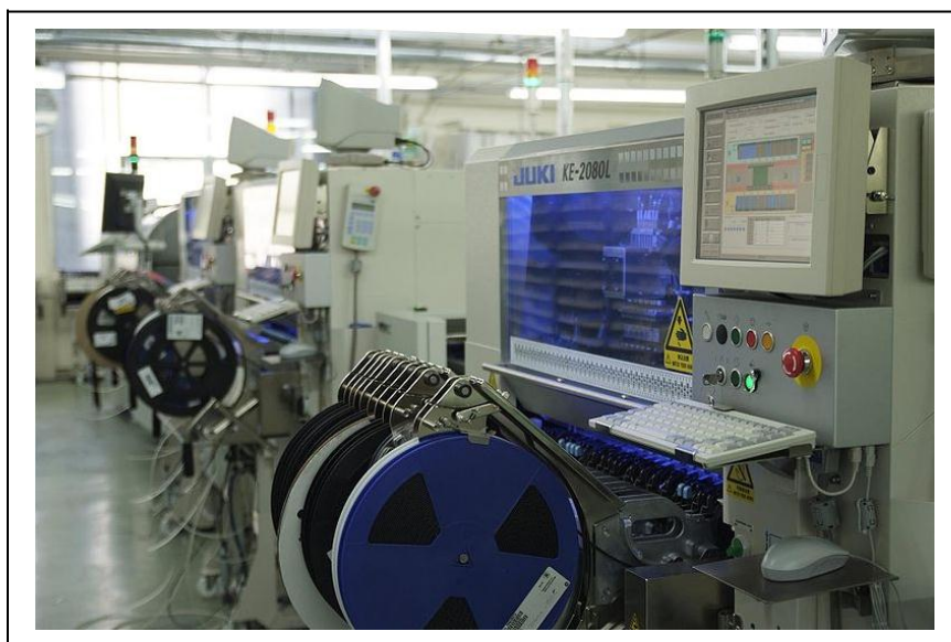
Figura 18: Máquinas inseridoras de componentes SMD. Fonte: Indústria Megger Ltda © .
