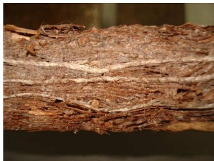
Figura 12: Vista das diferentes camadas de material da chapa de folhas em amostra sem acabamento
