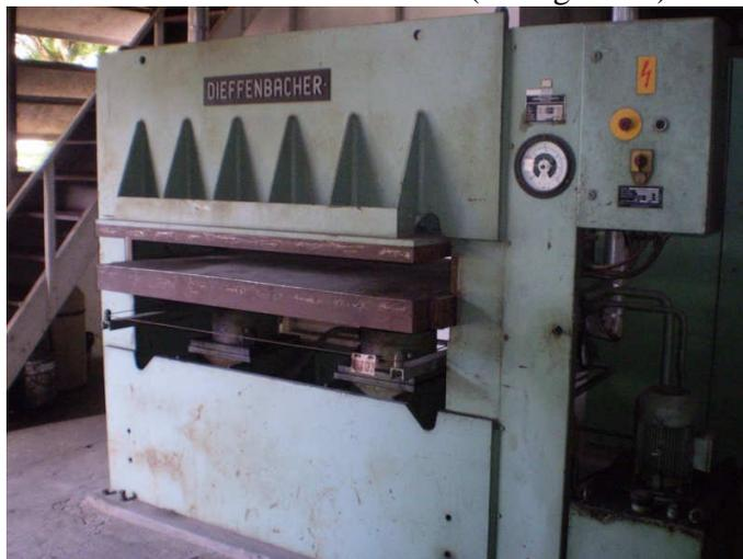
Figura 19: Prensa Hidráulica de 1,5 ton. do INPA.
