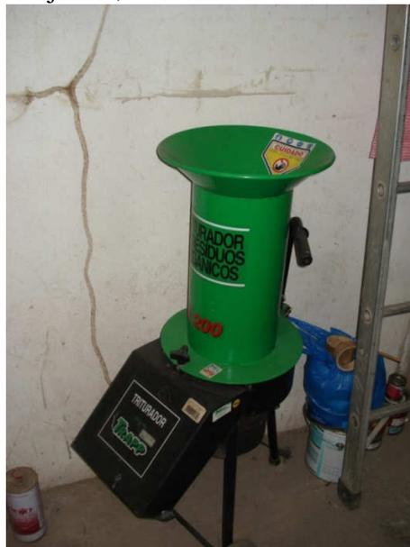
Figura 15: Triturador portátil utilizado no INPA.
