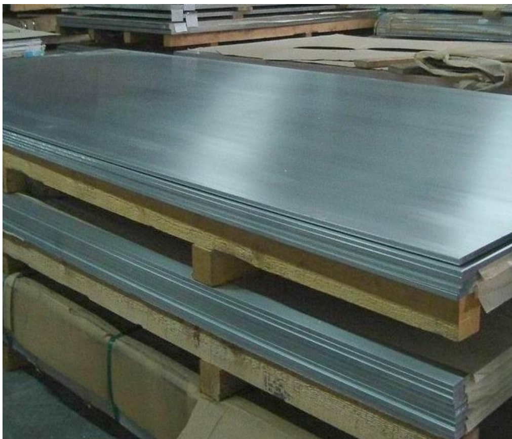
Figura 36: Madeira utilizada na separação das chapas antes do corte. Fonte: Fotografia na Metalúrgica M., tirada em maio de 2013.
