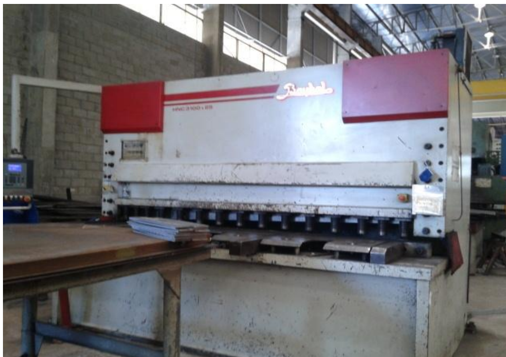
Figura 15: Máquina de corte das chapas. Fonte: Fotografia na Metalúrgica M., tirada em abril de 2013.
